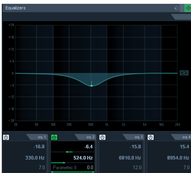
Slika 5.5: Ujednačavanje frekvencija bas gitare
