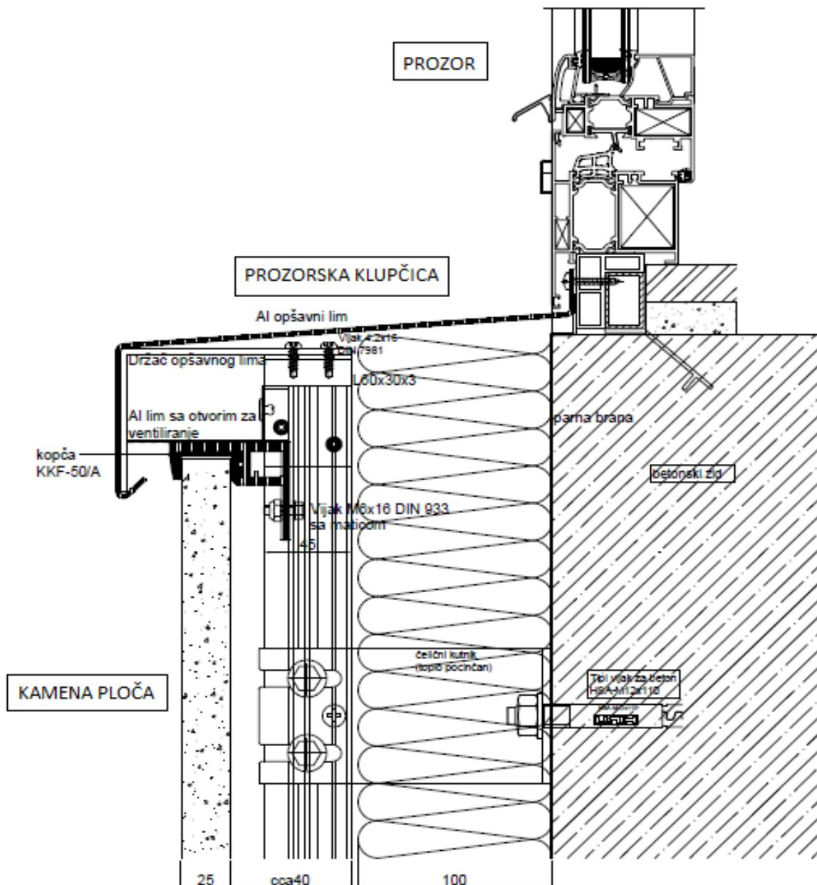
Slika 43. Spoj ventilirane fasade i prozorske klupčice
