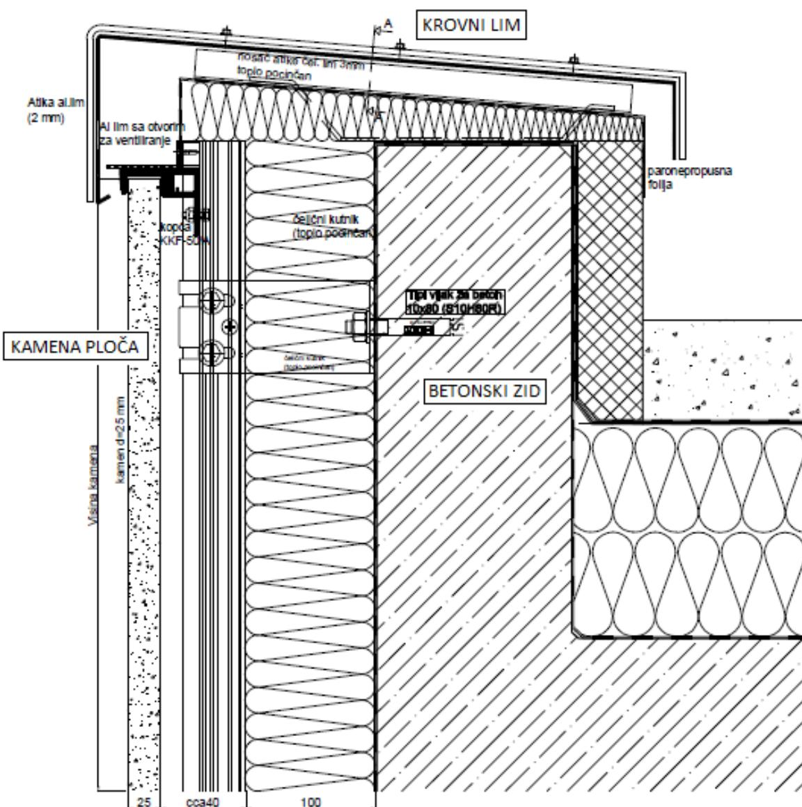
Slika 42. Vertikalni presjek spoja ventilirane fasade i krova
