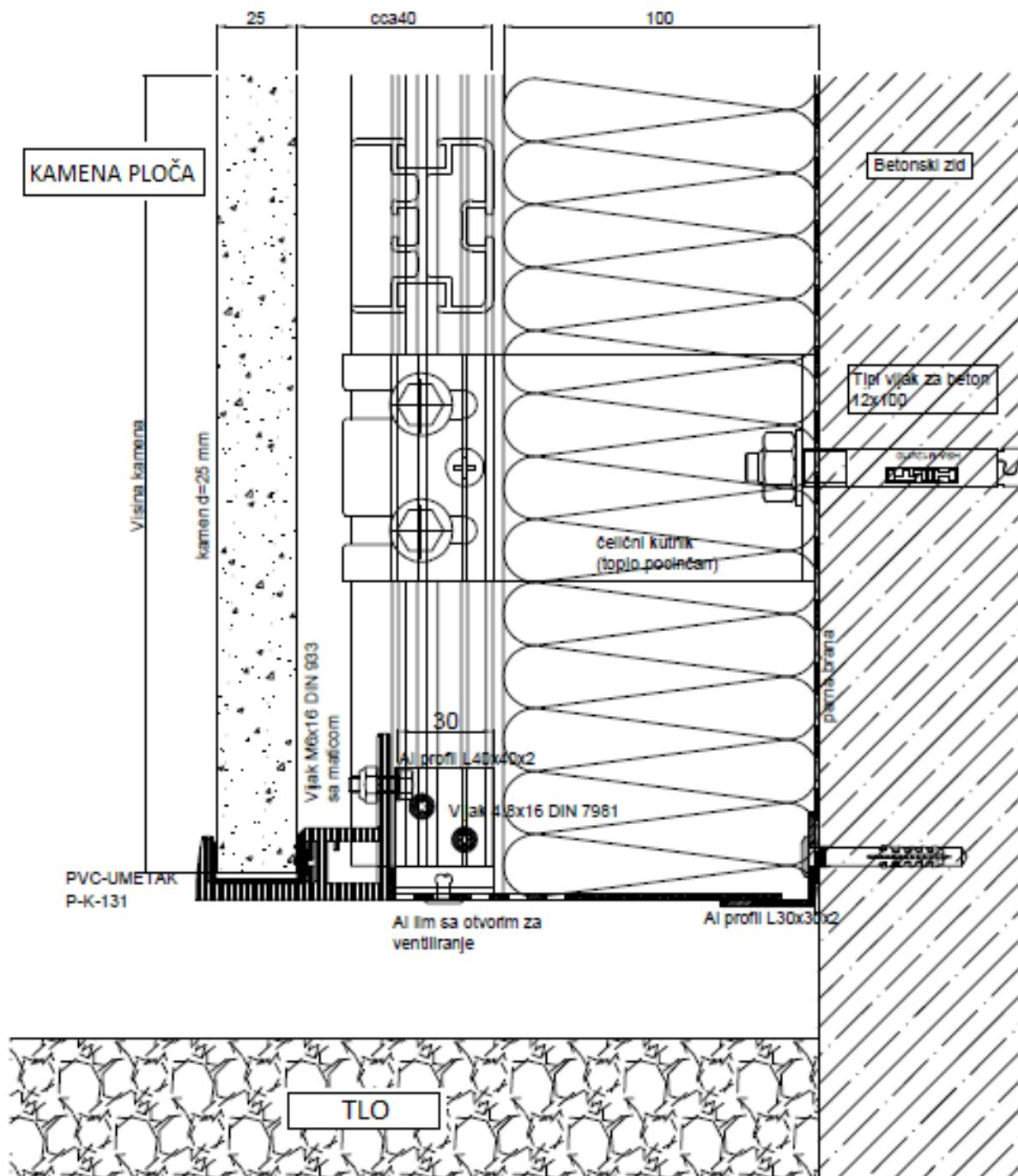
Slika 44. Spoj ventilirane fasade s tлом
