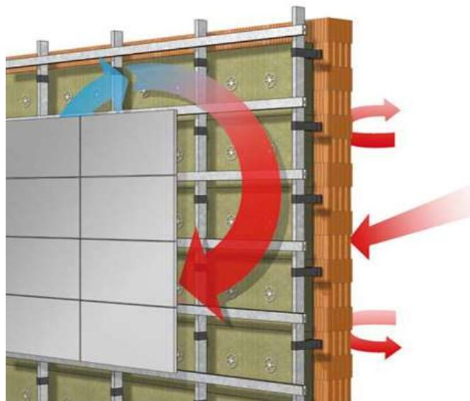
Slika 29. Ventilirana fasada kod zimskih niskih temperatura
