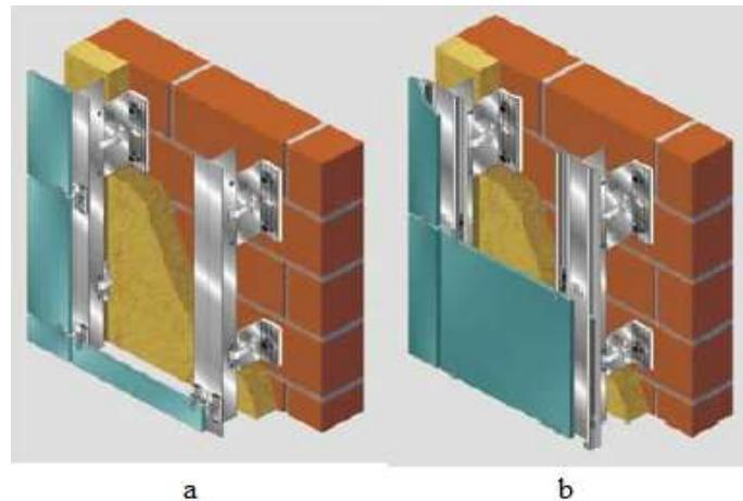
Slika 30. Ploče sa: a) vidljivim držaćima, b) vidljivim kopčama
