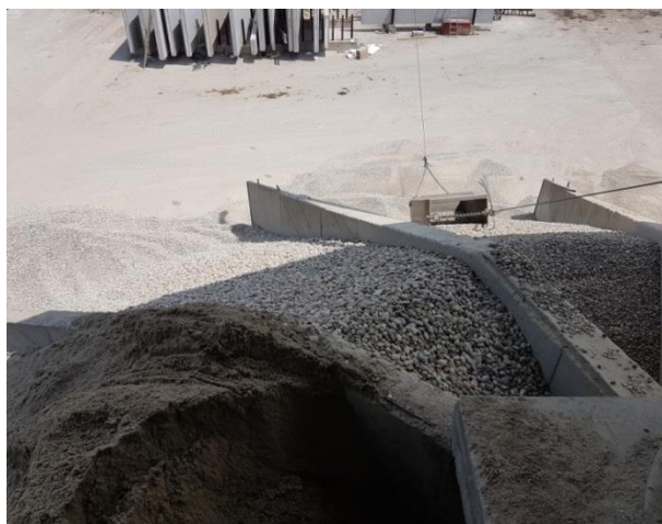
Slika 65. Kameni agregat raznih frakcija za proizvodnju betona
