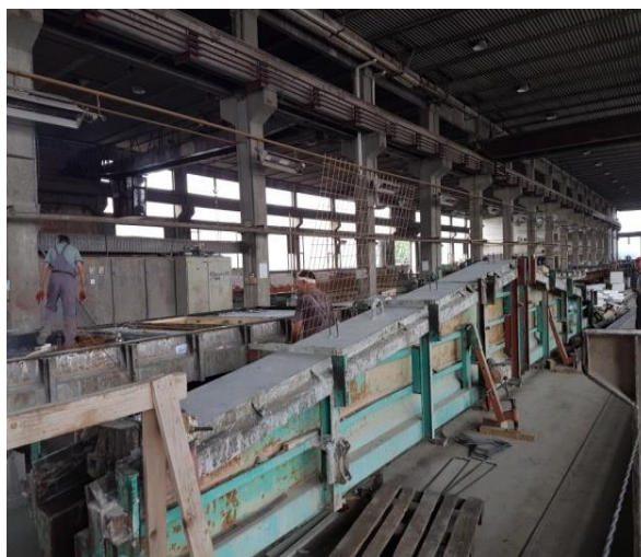
Slika 57. A nosač u oplati
