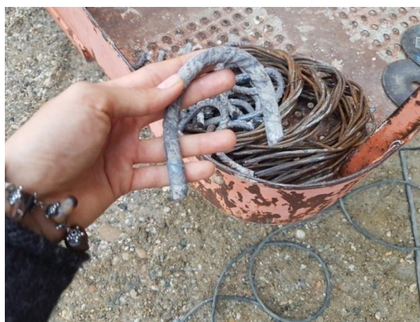
Slika 94. Odstranjena kuka sa sekundarnog nosača
