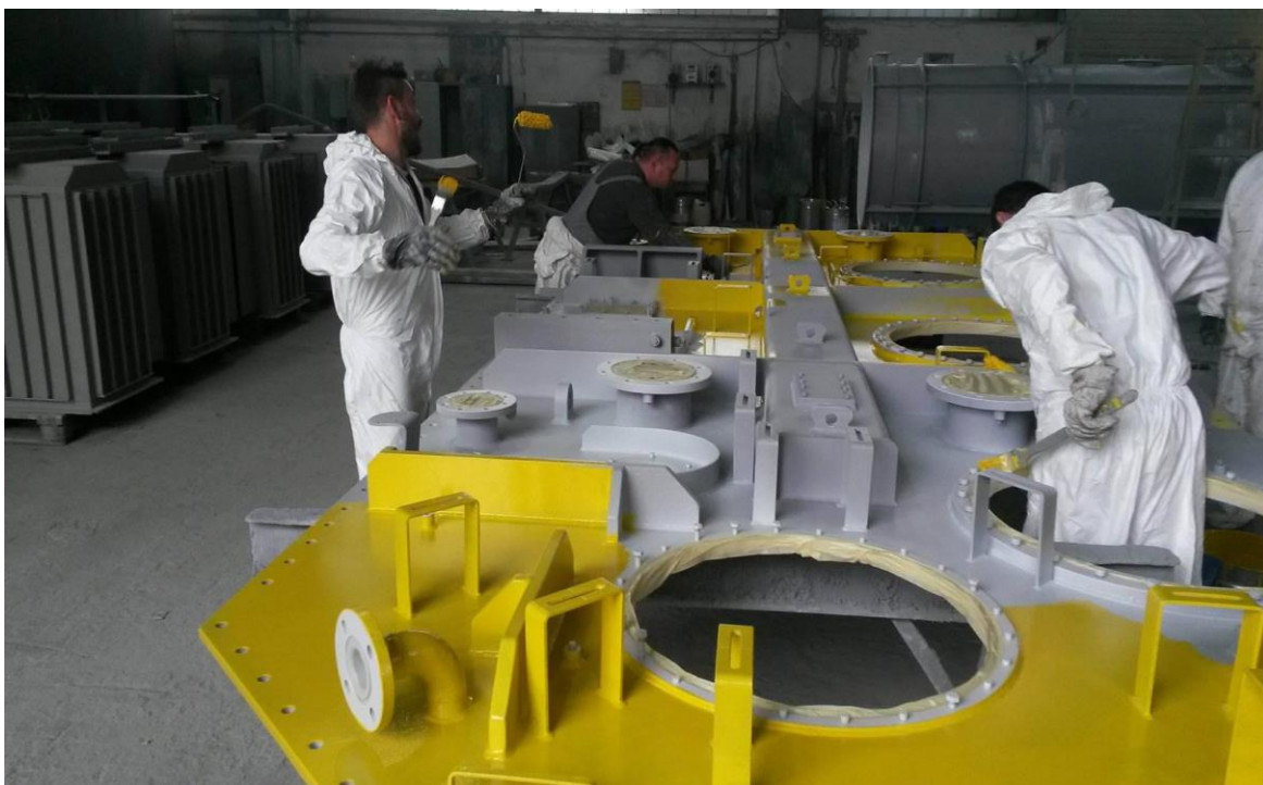
Slika 10. Nanošenje premaza valjcima
