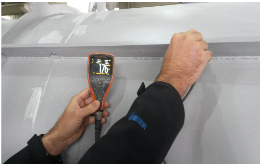
Slika 19. Mjerenje debljine suhog filma međusloja premaza
