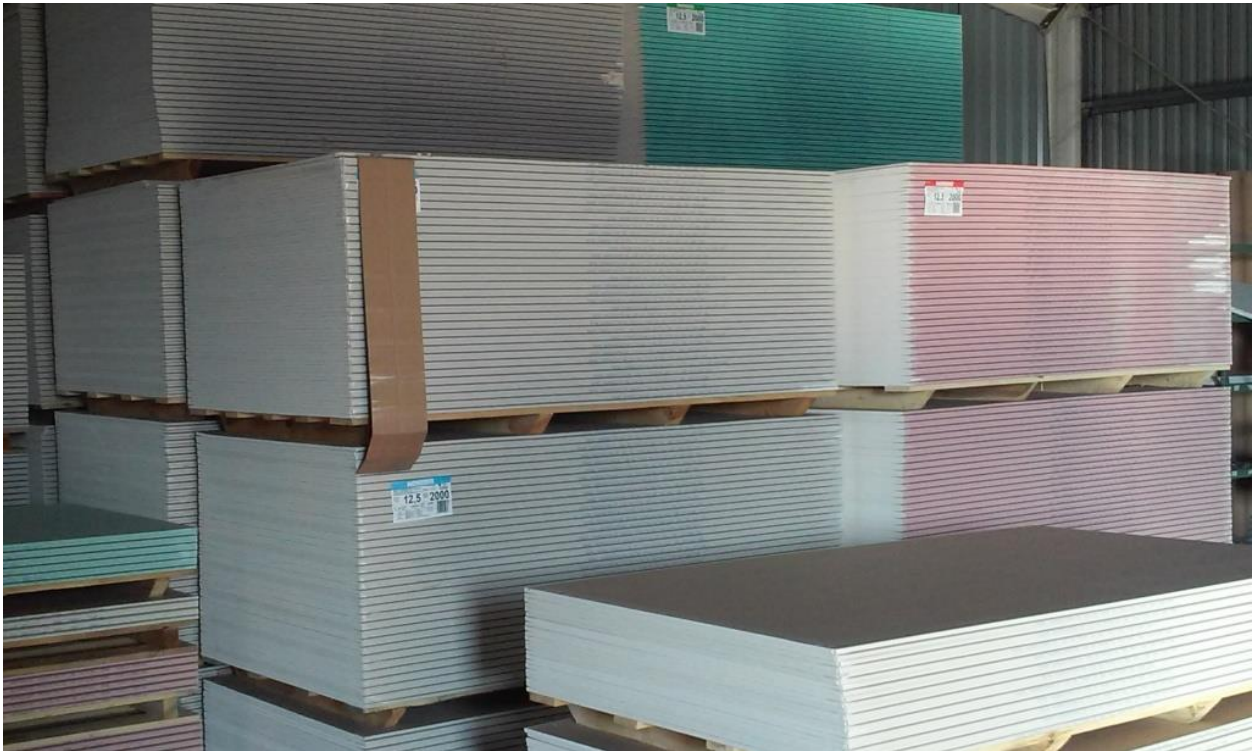
Slika 3.2. Gipskartonske ploče u bojama prema namjeni
