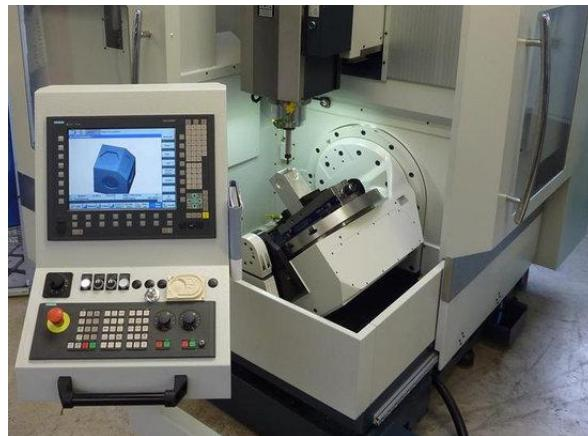
Slika 4.2 Slika konzole Siemens SINUMERIK 840D [8]
