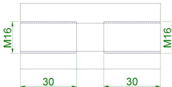
Slika 4.26 Urezivanje navoja M16
