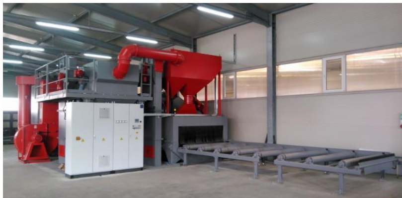
Slika 4.2 Protočni stroj za sačmarenje s valjkastim transporterom [3]
