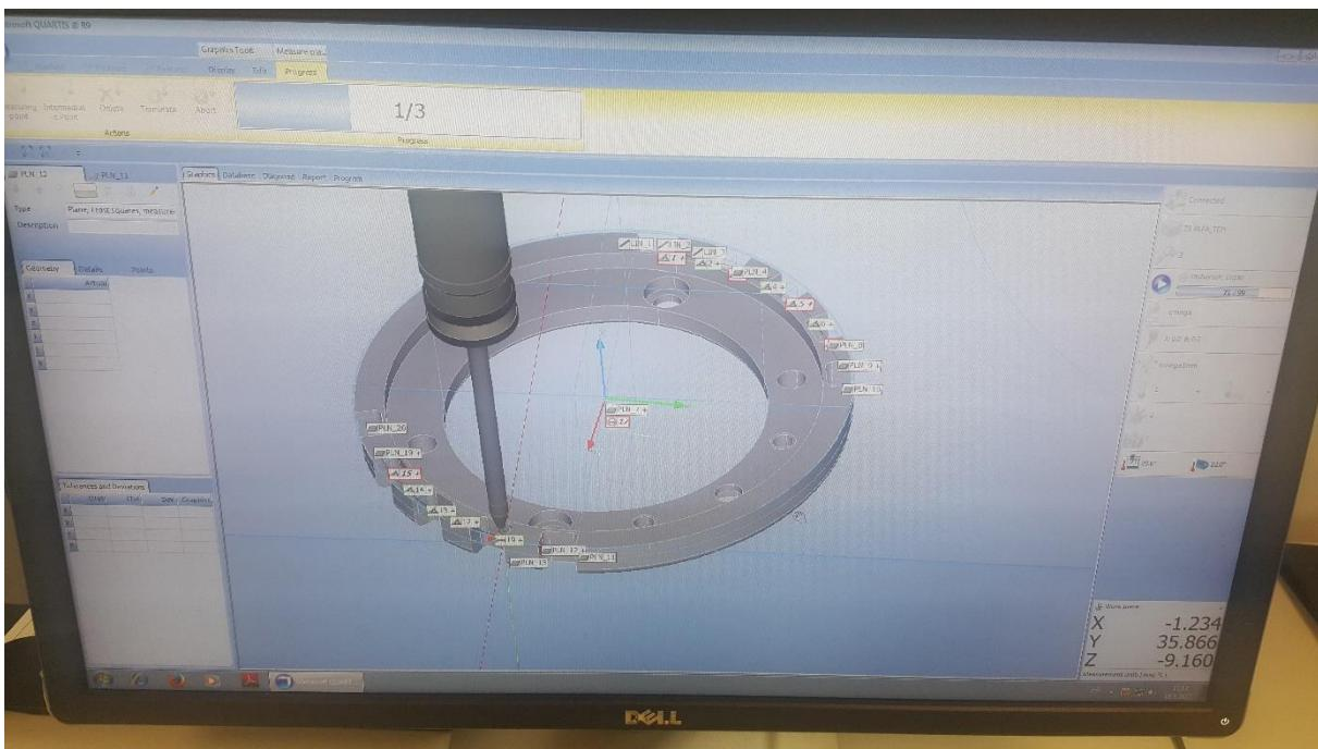
Slika 33. Grafički prikaz mjernog komada na računalu
