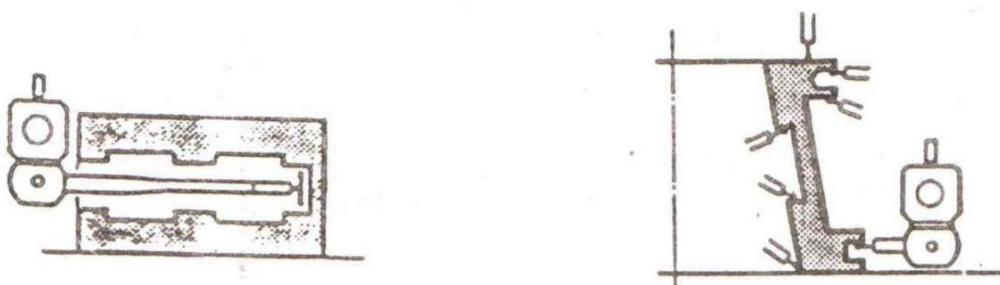
Slika 16. Primjene motoriziranih mjernih sondi [12]
