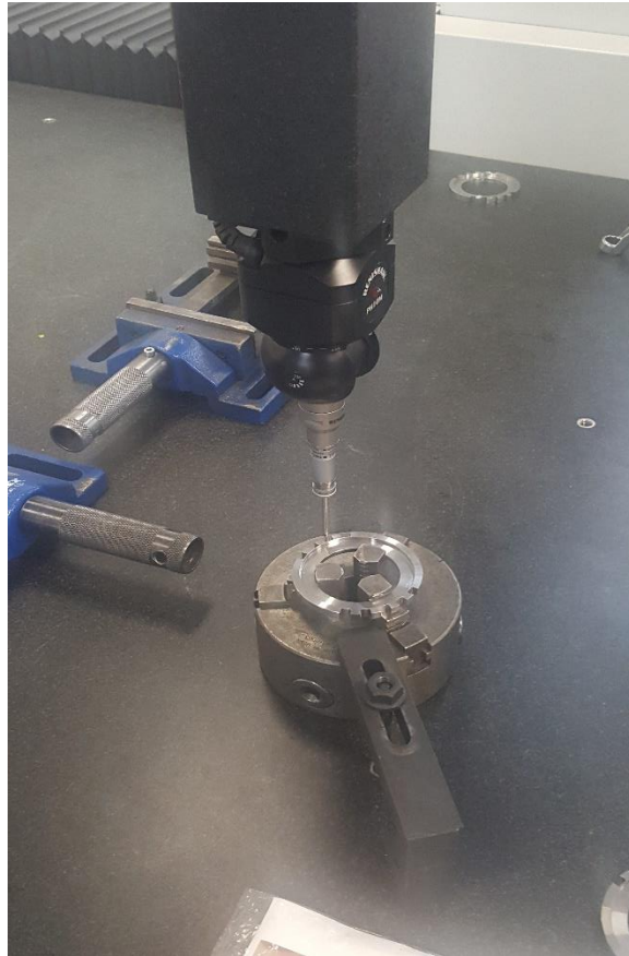
Slika 36. Mjerenje razmaka između zubiju
