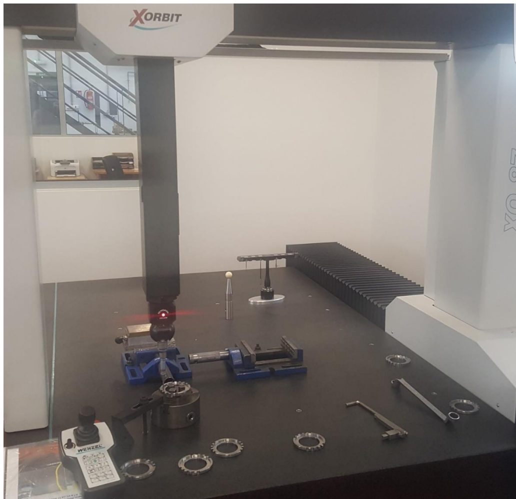
Slika 35. Prikaz mjerenja prvog komada
