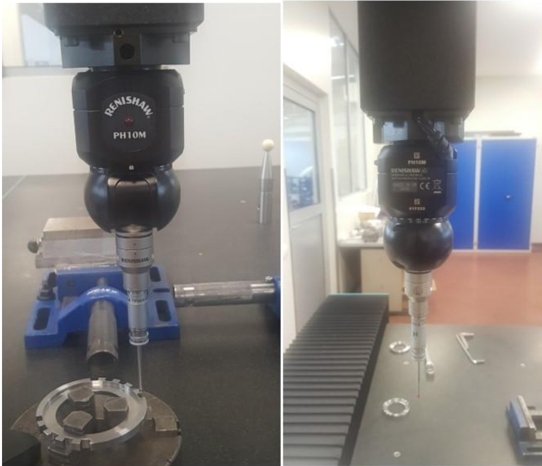
Slika 24. Renishaw PH10M mjerna sonda
