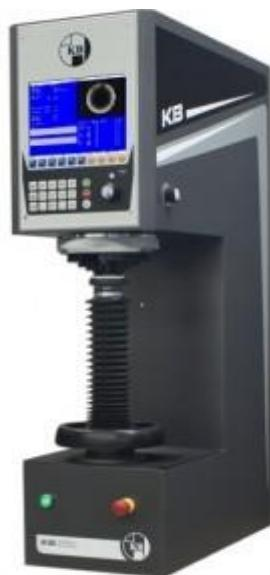
Slika 15. Uredaj za ispitivanje tvrdoće po Brinellu [17]
