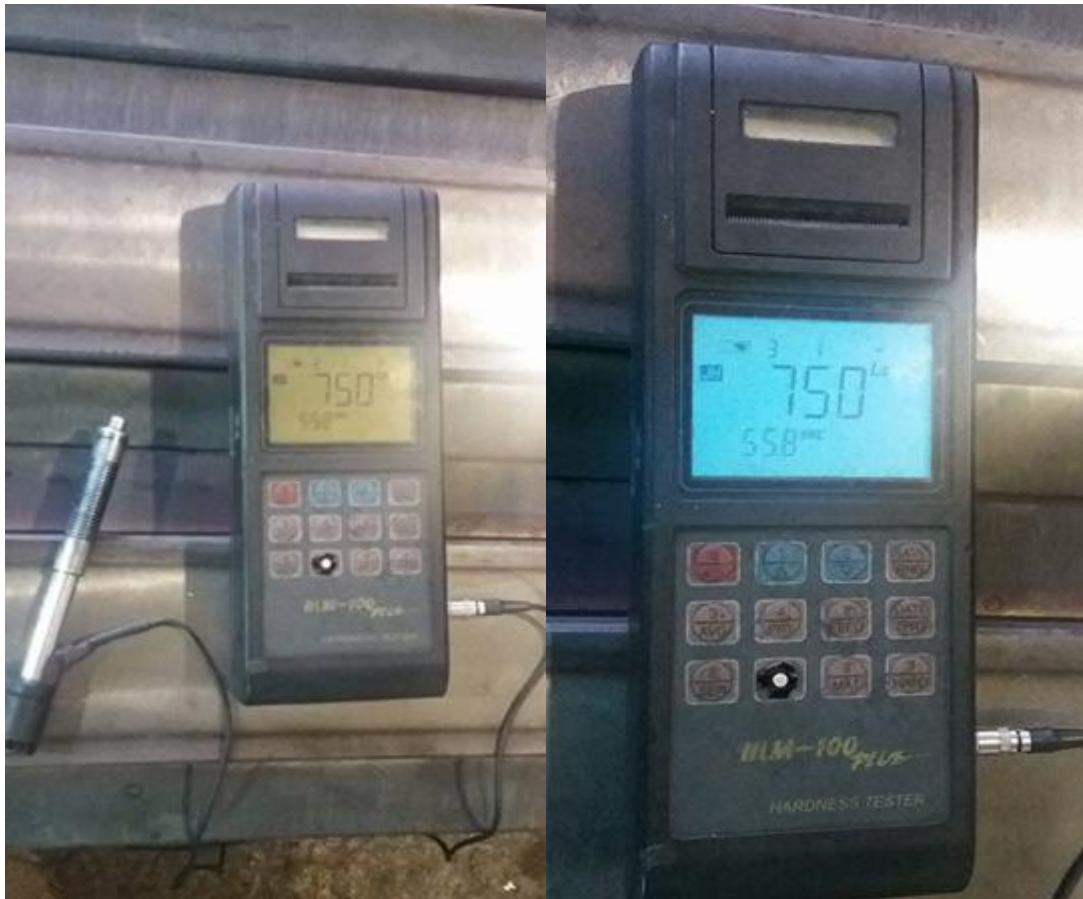
Slika 26. Uređaj za mjerenje tvrdoće( HLM-100 PLUS)
