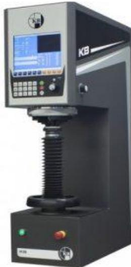
Slika 17. Aparat za ispitivanje tvrdoće po Rockwellu [17]
