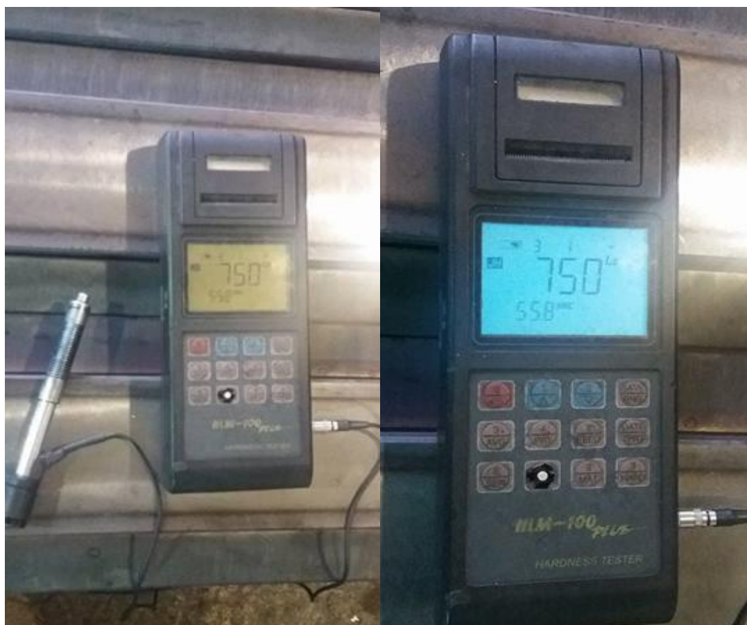
Slika 26. Uređaj za mjerenje tvrdoće (HLM-100 PLUS)
