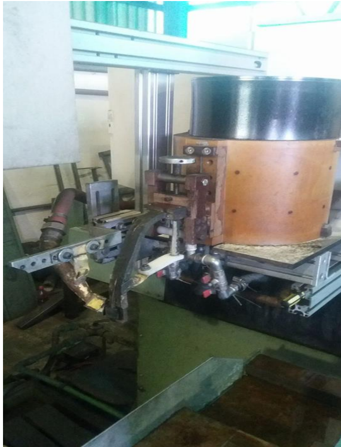
Slika 27. Stroj za indukcijsko kaljenje
