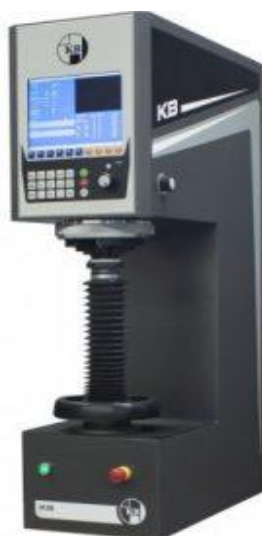
Slika 17. Aparat za ispitivanje tvrdoće po Rockwellu [17]
