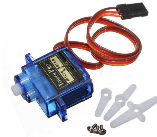
Slika 6.5. Servo motor SG90 [56]
