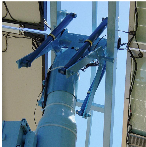
Slika 5.10. Glava Zomework-ovog pasivnog sustava za praćenje Sunca [54]
