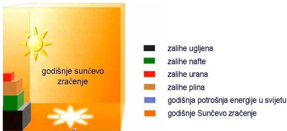
Slika 2.2. Godišnja usporedba Sunčevog zračenja na površini Zemlje s godišnjom potrošnjom energije u svijetu, te zalihamo fosilnih i nuklearnih goriva [36]
