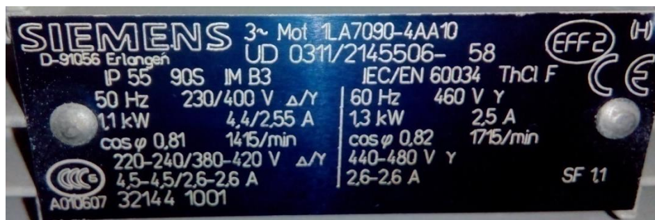
Slika 31. Podaci sa pločice trofaznog asinkronog motora
