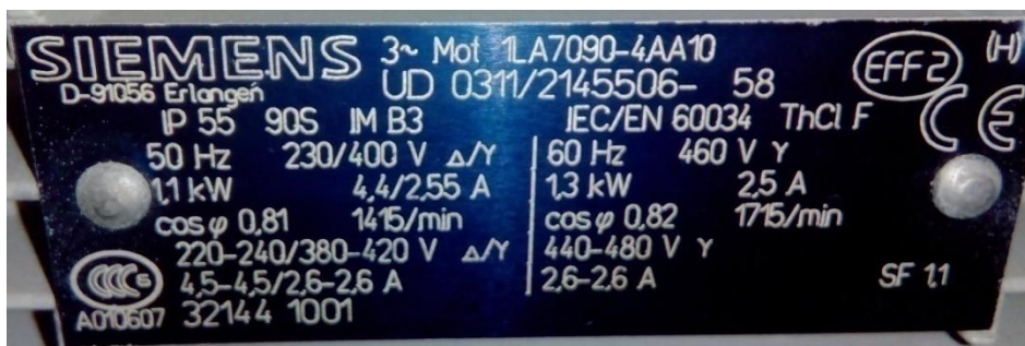
Slika 31. Podaci sa pločice trofaznog asinkronog motora
