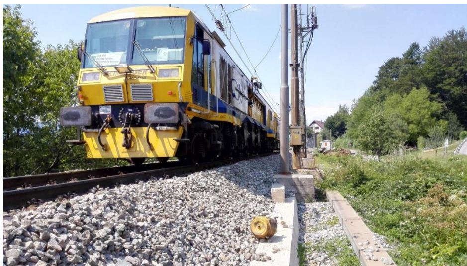
Slika 30. Stroj za reprofiliranje tračnica [13]
