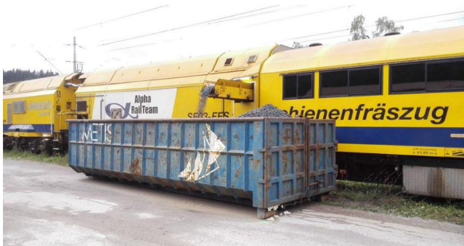
Slika 31. Istovar otpada (špene) u metalni kontejner [13]
