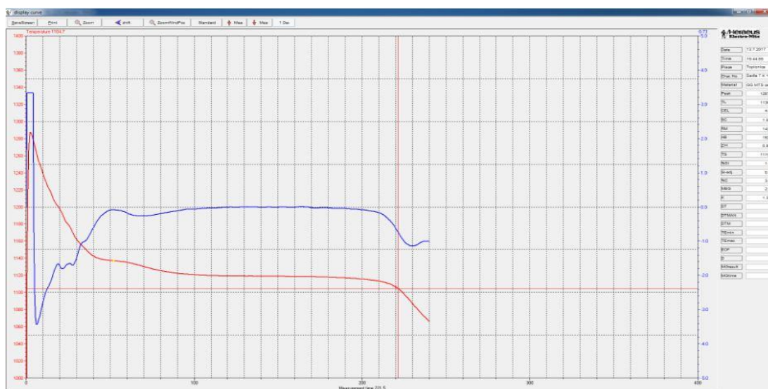
Slika 3.6 Krivulja hlađenja taline nodularnog lijeva [19]
