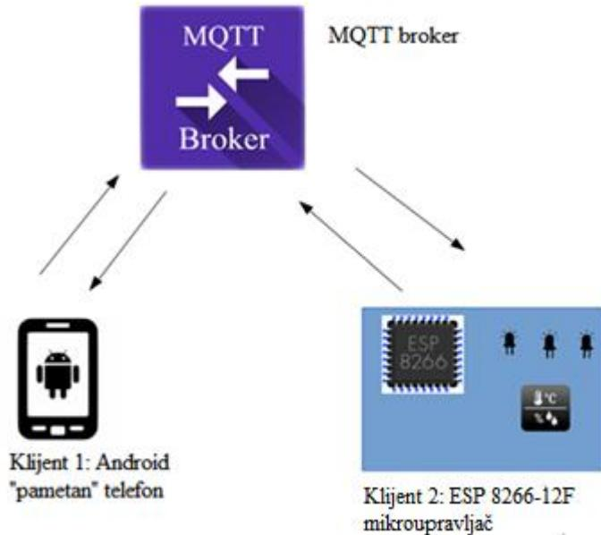
Slika 6.1 Koncept izvedenog sustava za demonstraciju MQTT protokola
