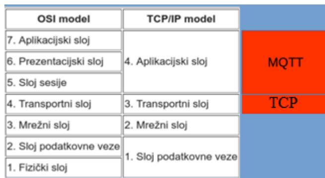
Slika 2.1 Prikaz MQTT protokola u OSI i TCP/IP mrežnom modelu
