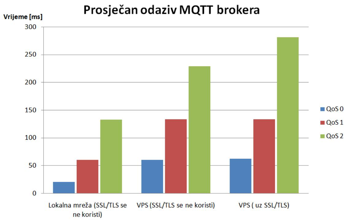
*Slika 9.1 Dijagram prosječnog odaziva MQTT broker-a*
