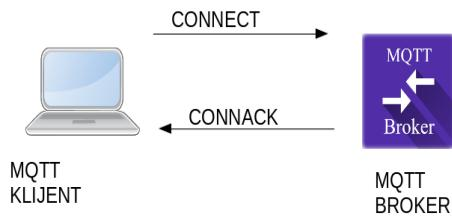
*Slika 2.3 Uspostava veze između MQTT klijenta i brokera*
