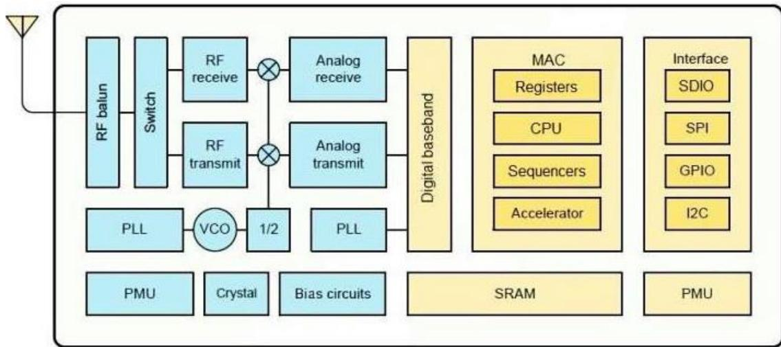
Slika 7.2 Prikaz blok dijagrama ESP8266EX integriranog sklopa [11]
