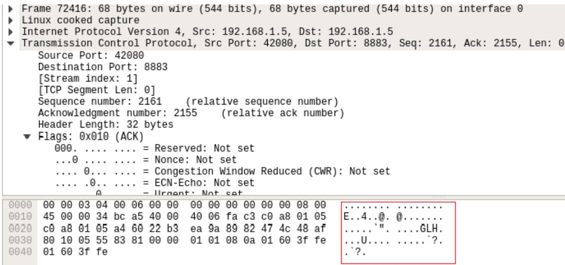
Slika 6.14 Prikaz zarobljenih paketa MQTT protokola uz korištenje TLS/SSL protokola
