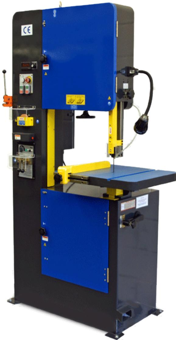
Slika 5.14. Vertikalna tračna pila. [24]
