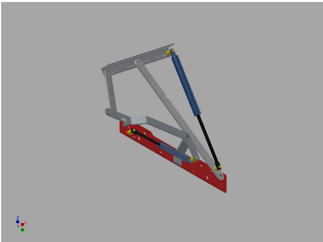
Slika 2.9. Primjer mehanizam sa funkcijom „horizontalnog podizanja“ – stražnja strana
