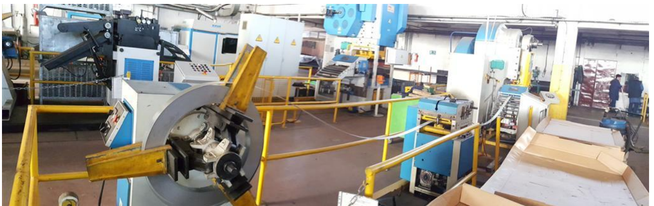
Slika 9.5.2. Linija za štancanje sa prešom od 160 tona
