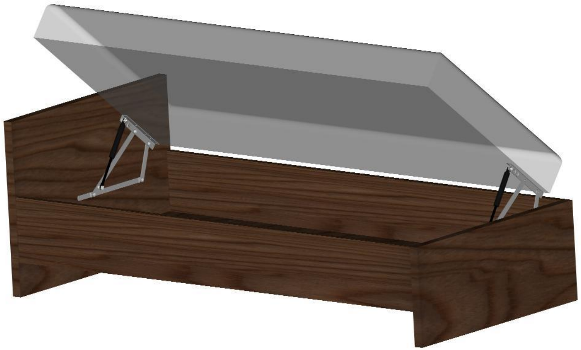
Slika 1.9. krevet sa poprečnim podizanjem i ugrađenim lift mehanizmom za podizanje
