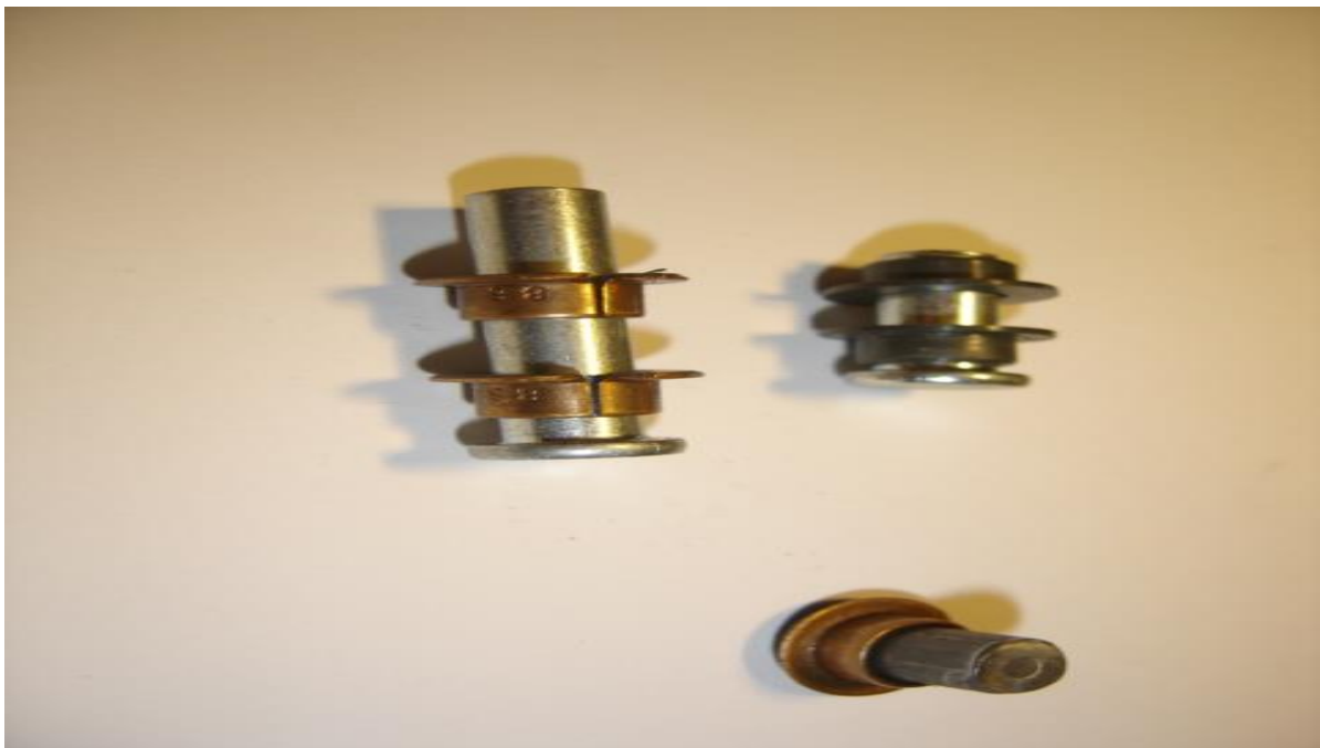
Slika 9.4.4. Primjer pune zakovice i pobakrenog kliznog ležaja korištenog na testu
