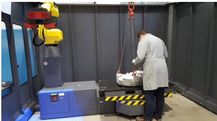
Slika 2.10 Namještanje gravure u ScanBox [5]
