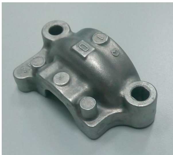
Slika 3.1 Odljevak pokrova kugličnog ležaja
