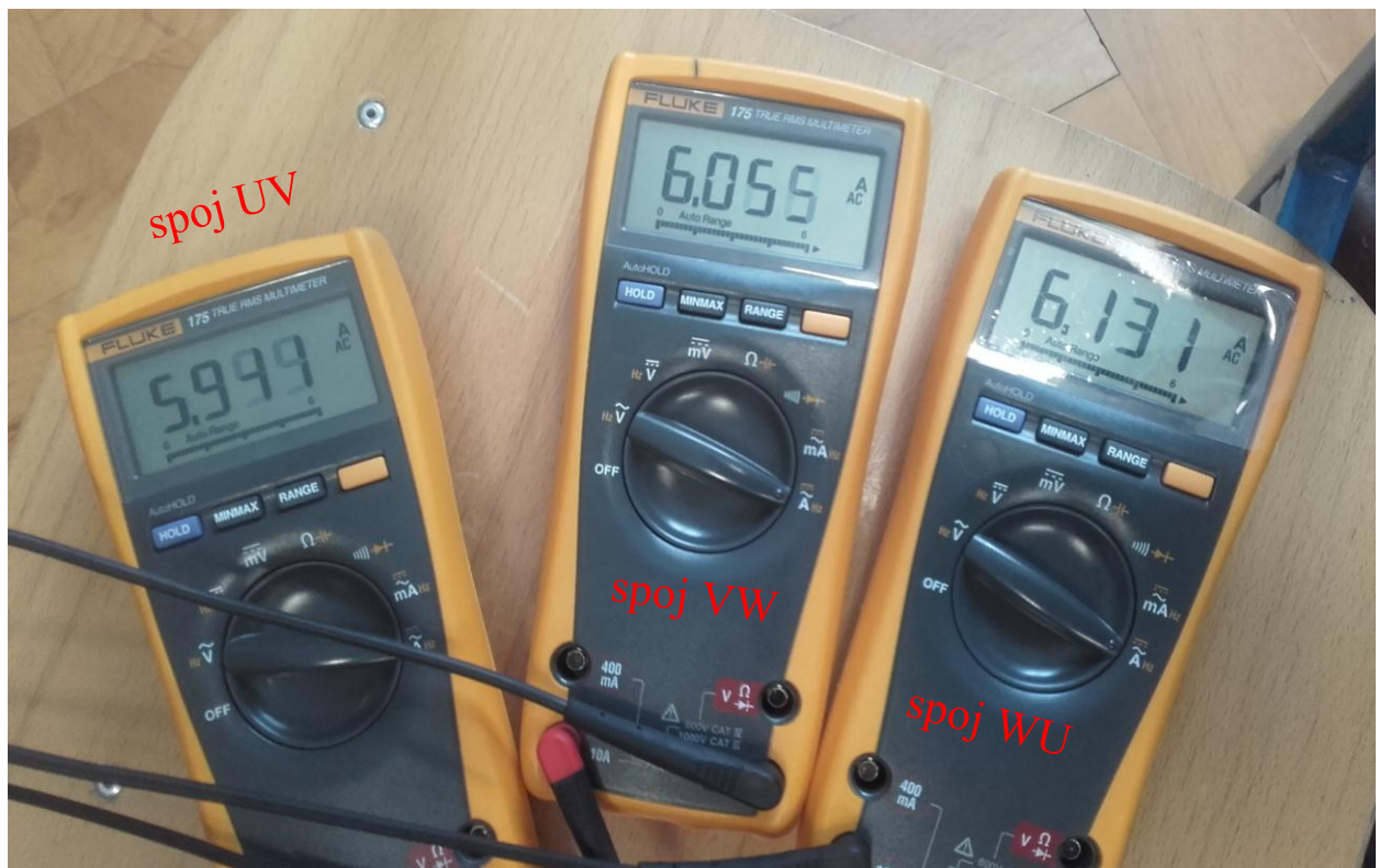
Slika 3.3.2 Vrijednosti struja kod krivih spojeva U, V i W
