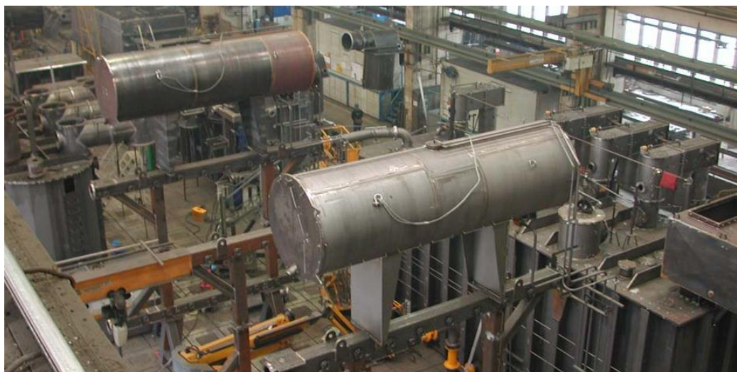
Slika 2.8.4.1 Prikaz izrade konzervatora u tvornici Končar [6]
