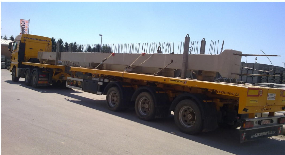
Slika 11: Transport gotovog predgotovljenog armiranobetonskog elementa- stupa
