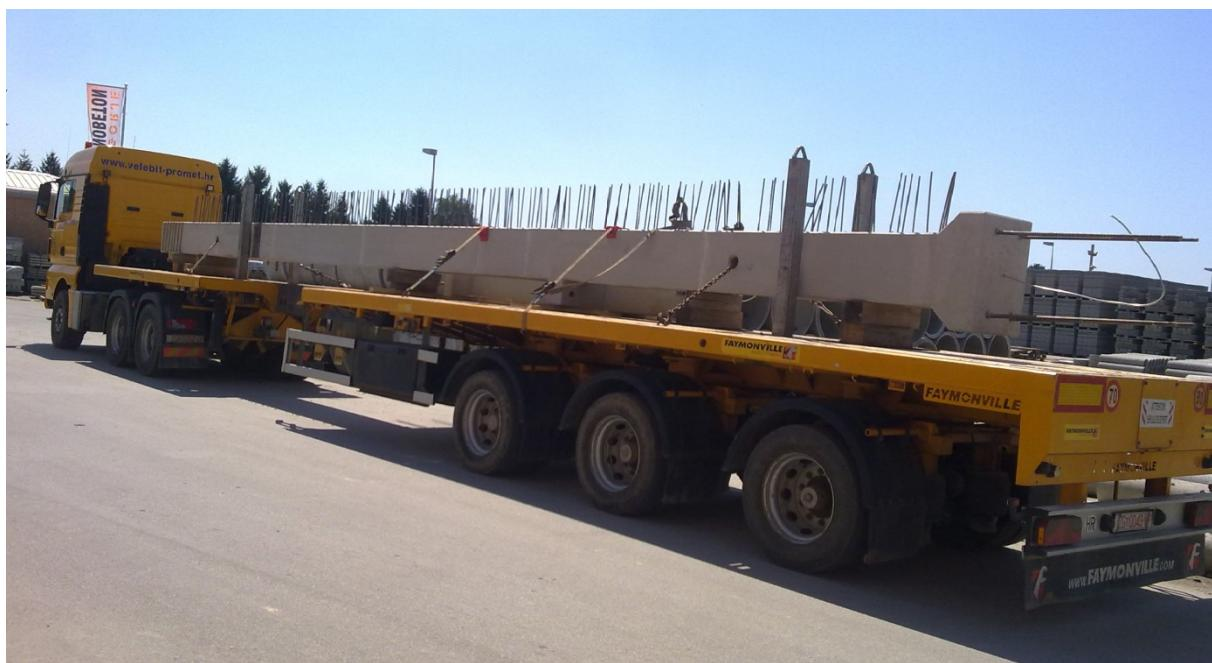
*Slika 11: Transport gotovog predgotovljenog armiranobetonskog elementa- stup*
