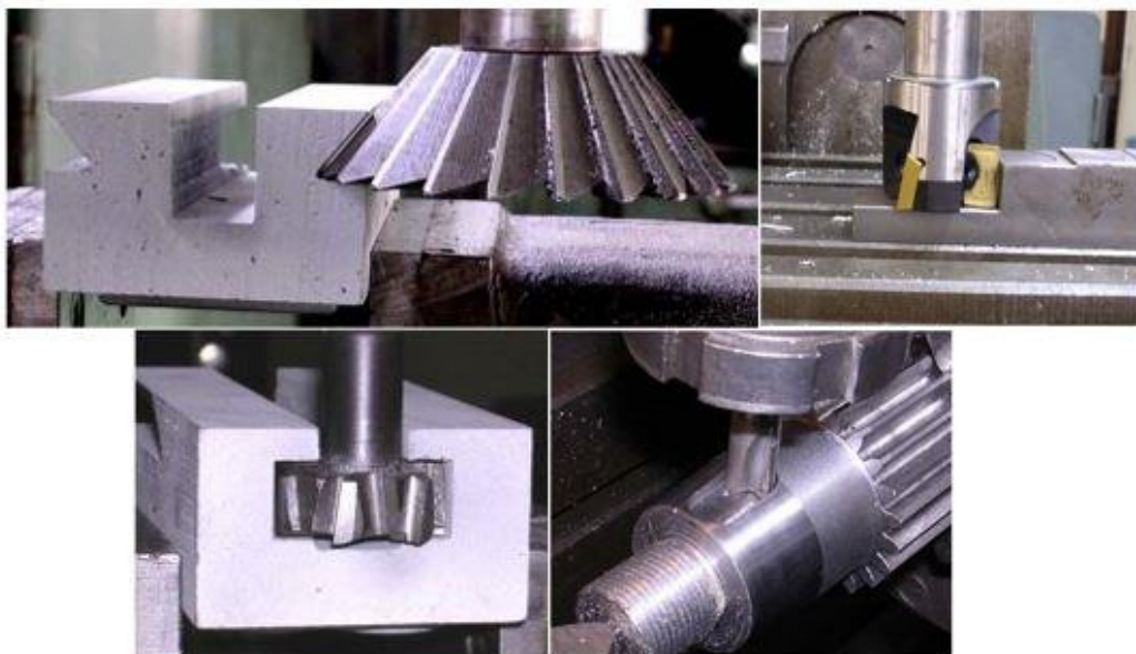
Slika 2.6 Postupci glodanja vertikalnom glodalicom [6]
