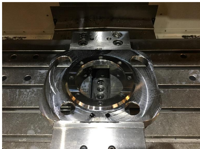
Slika 8.10 Čeono glodanje (izrada konture) [8]
