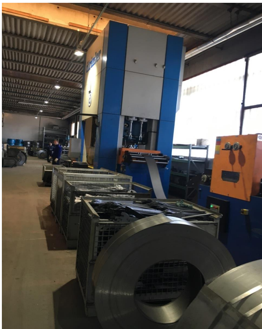
Slika 2. Štanca Dirinler COCK4000 PMU[1]
