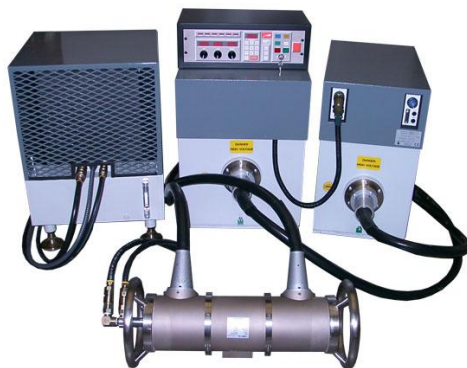
Slika 5. Standardna operama industrijskog aparata za ispitivanje x-zrakama [2]
