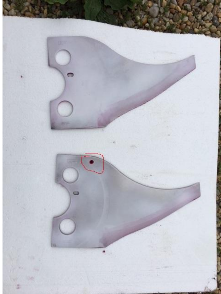
Slika 30 . Uočena površinska pogreška [autorska]
