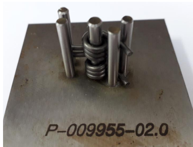
Slika 6.1 Improvizirani Poka-Yoke uređaj
