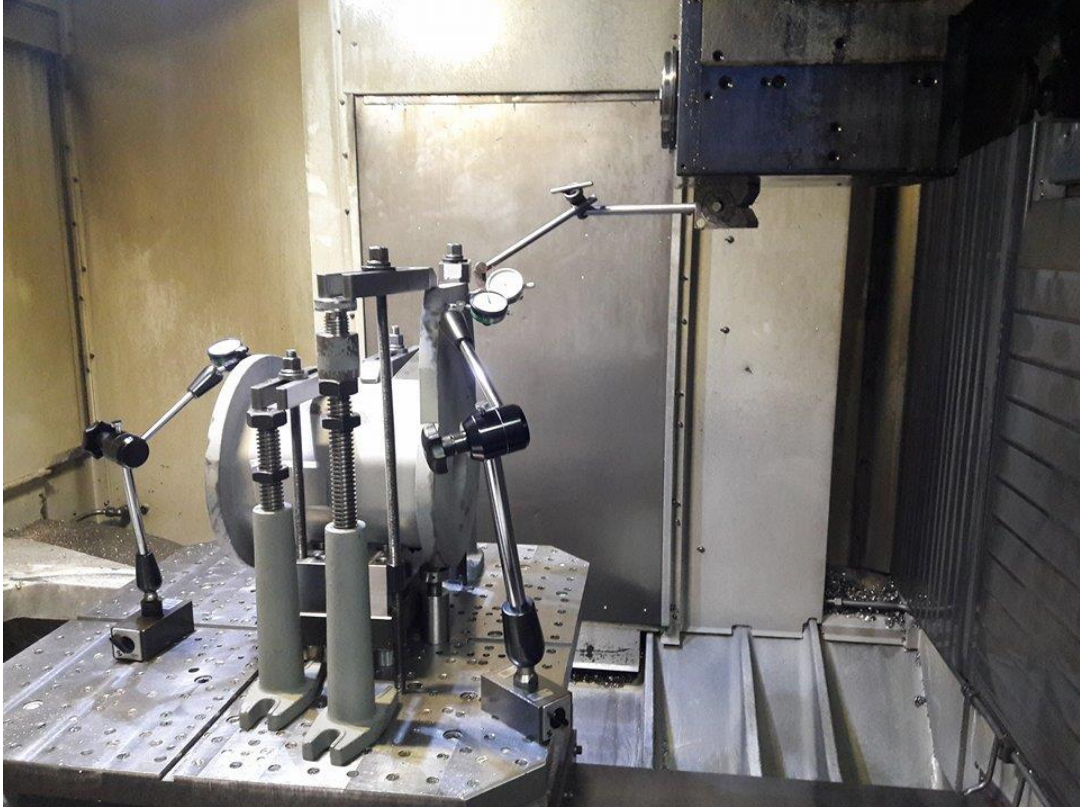
Slika 15. Pozicioniranje proizvoda na stroju prije strojne obrade
