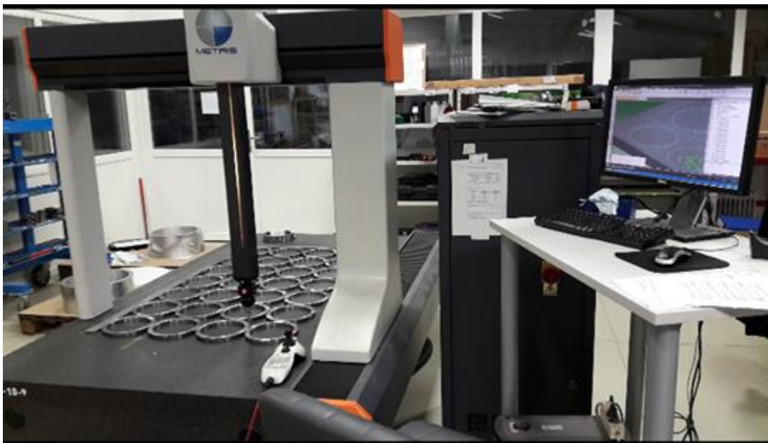
Slika 14. Trokoordinatni mjerni uređaj Metris
