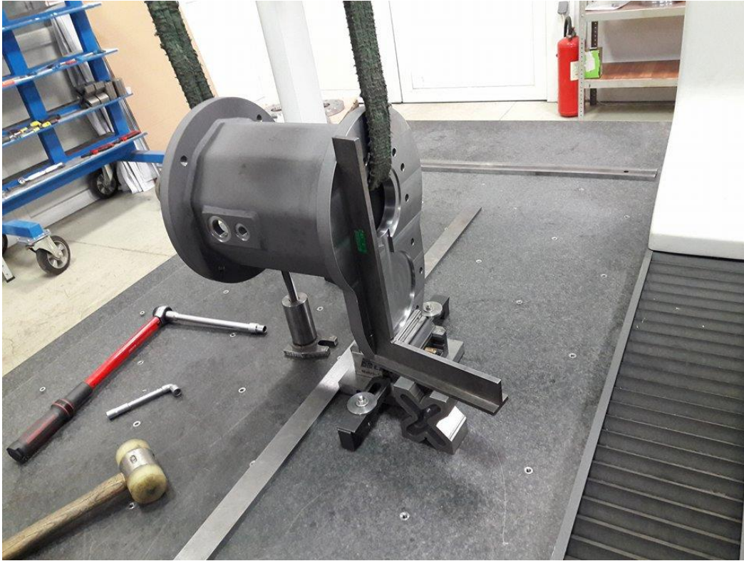
Slika 17. Pozicioniranje proizvoda na stolu mjernog uređaja
