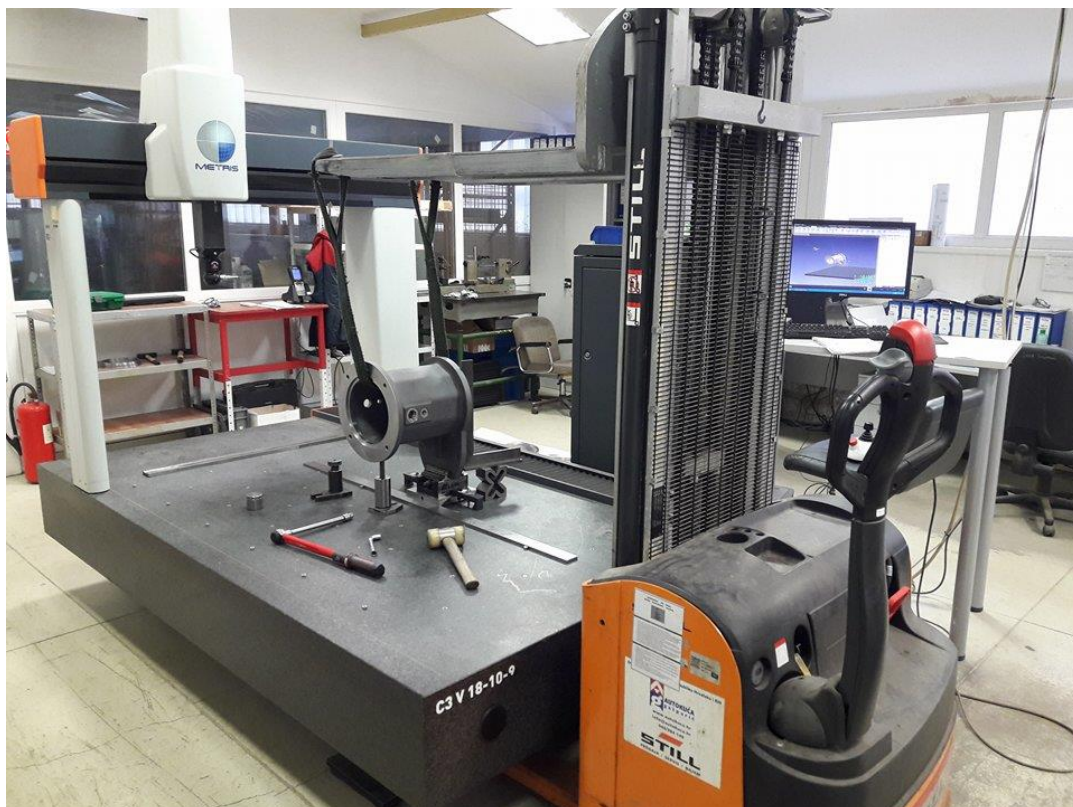
Slika 16. Postavljanje proizvoda na stol mjernog uređaja Metris
