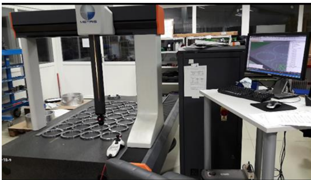
Slika 14. Trokoordinatni mjerni uređaj Metris
