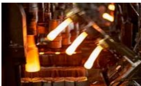
Slika 13. Proizvodnja (oblikovanje) staklene mase
