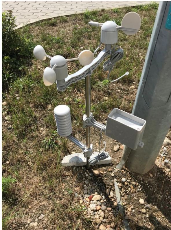
Slika 7.1: Vjetrostanica za mjerenje snage vjetra
