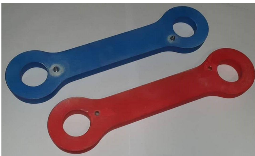
Slika 4.13 Model gornjak i model donjak s unutarnje strane
