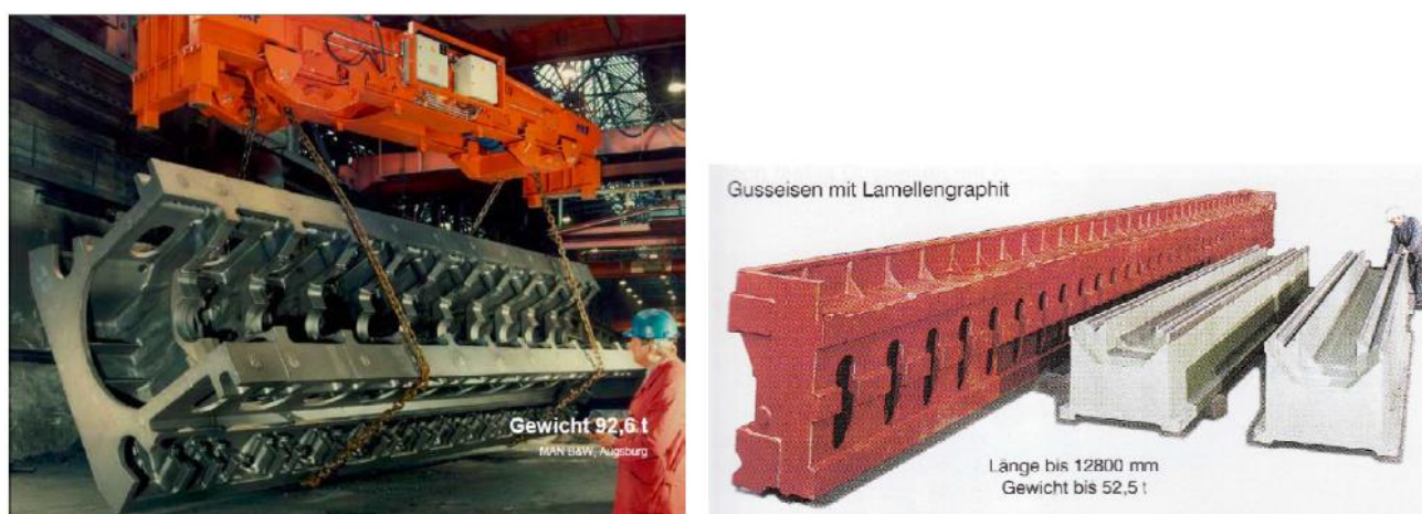
Slika 2.3 Blok brodskog diesel motora i postolja alatnih strojeva [2]
