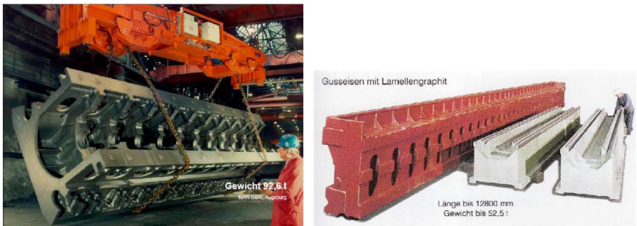
Slika 2.3 Blok broskog diesel motora i postolja alatnih strojeva [2]
