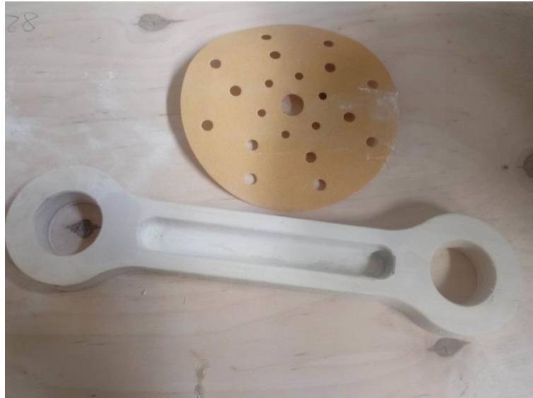
Slika 4.6 Model nakon grubog brušenja
