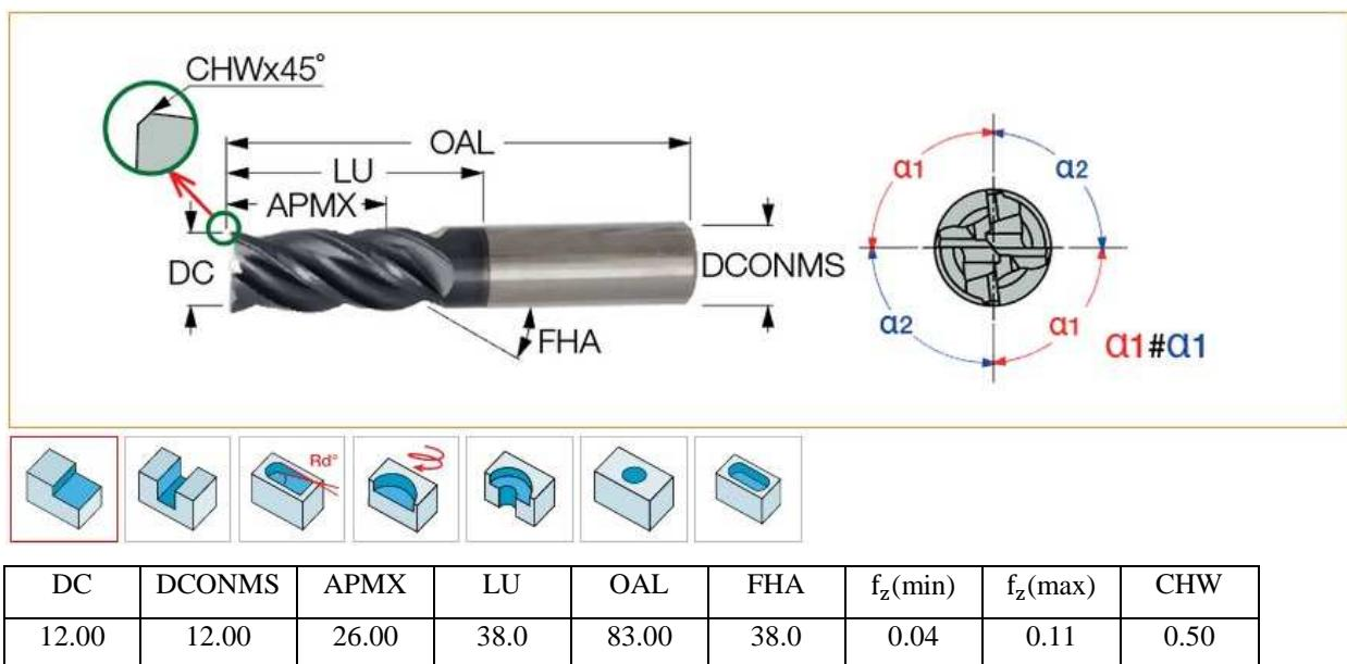
Slika 4.19 Glodalo za izradu ravnih površina
