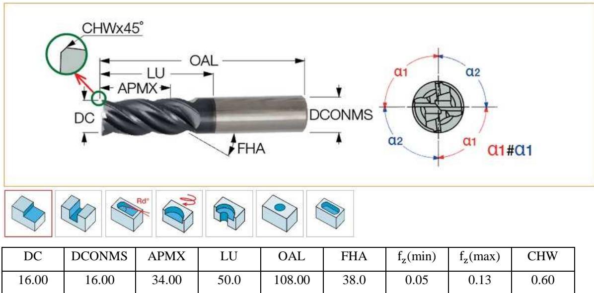
Slika 4.20 Glodalo  $\Phi 16$  za proširivanje provrta
