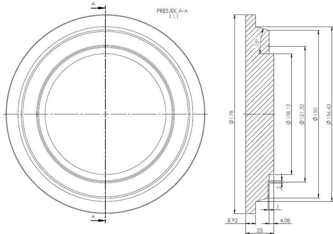
*Slika 4.5 Nacrt gornje ploče kalupa*
