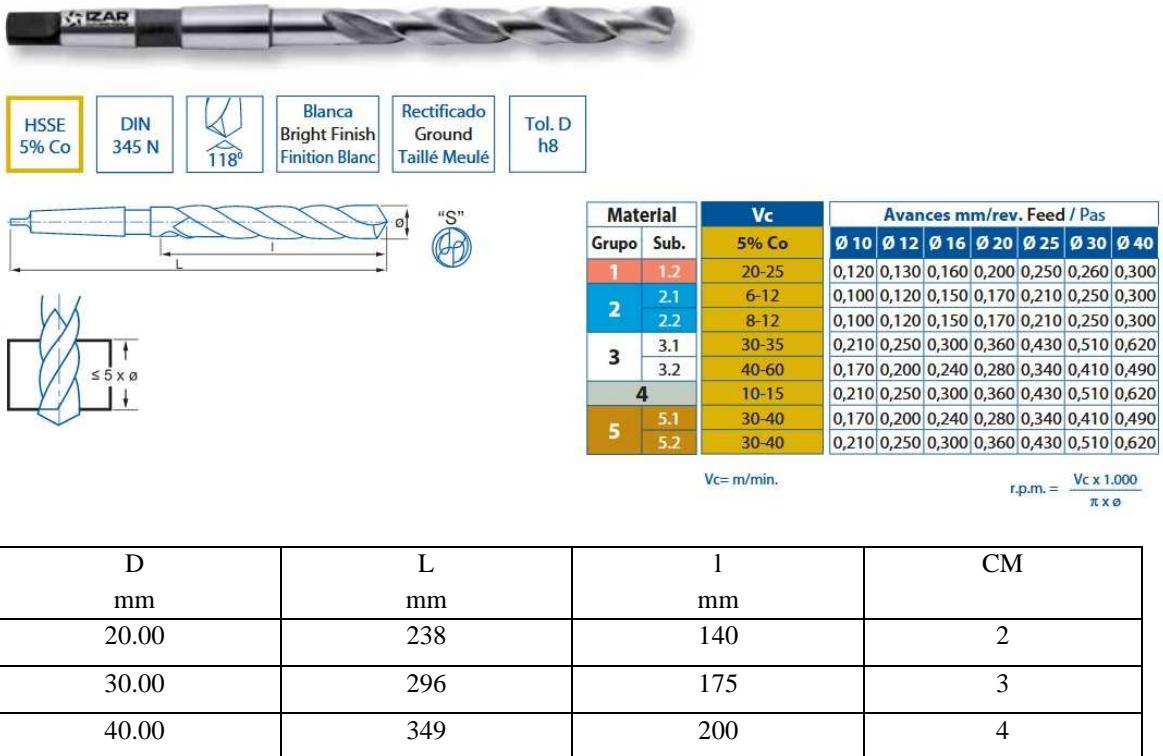
Slika 4.7 Svrđla promjera 20, 30 i 40 mm za bušenje središnjeg provrta.
