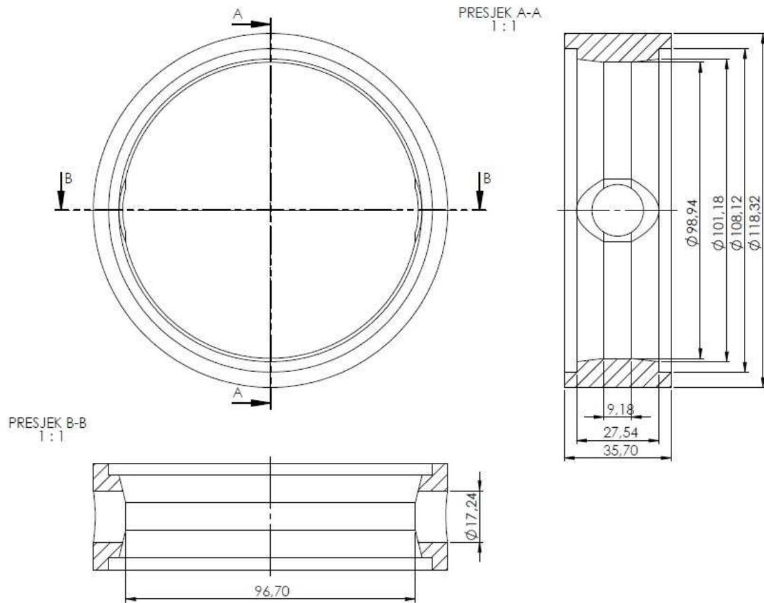
Slika 2.4 Brtva leptir ventila DN 100 s dimenzijama uvećanim 2%
