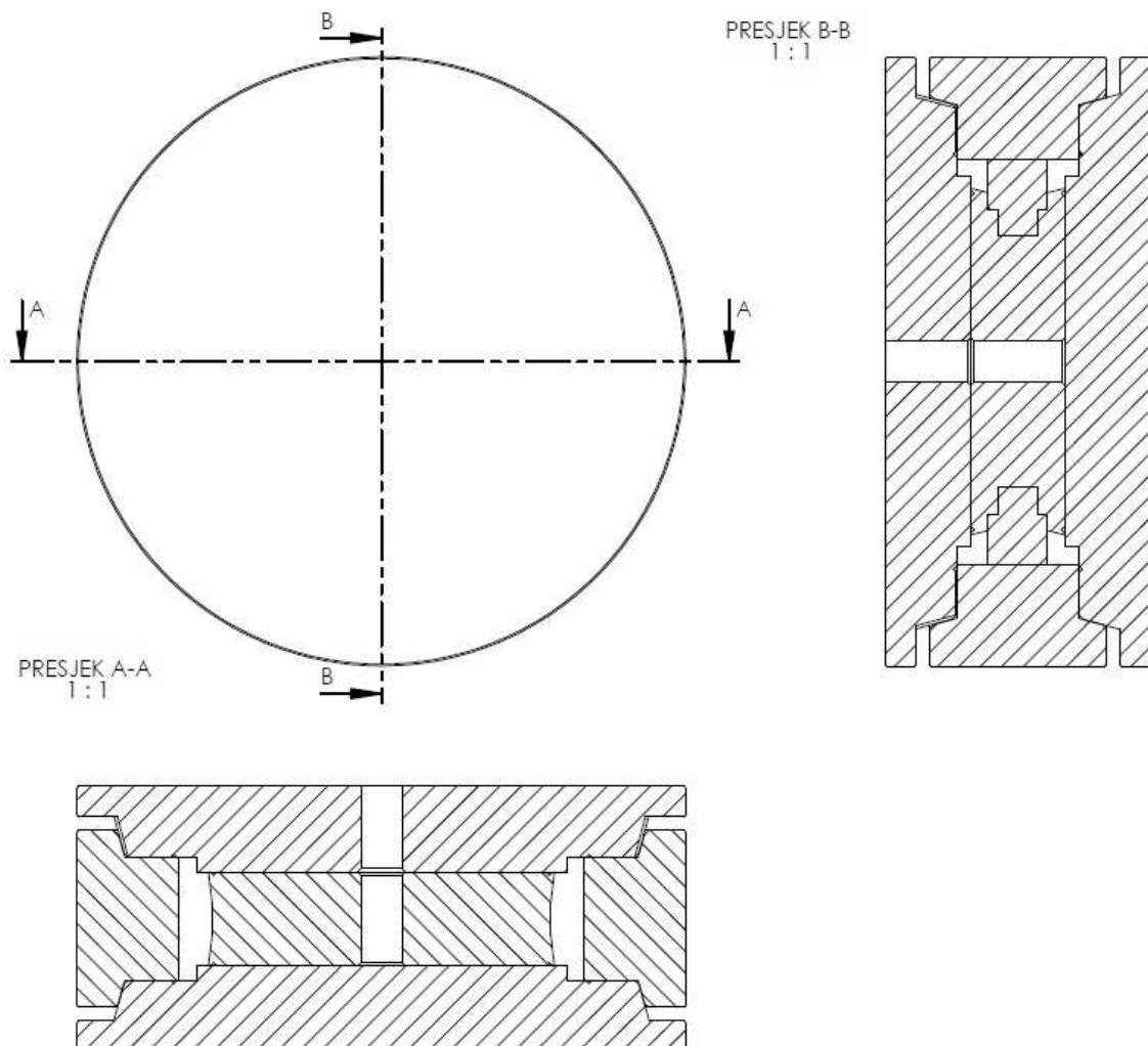
Slika 2.5 Konačni izgled kalupa
