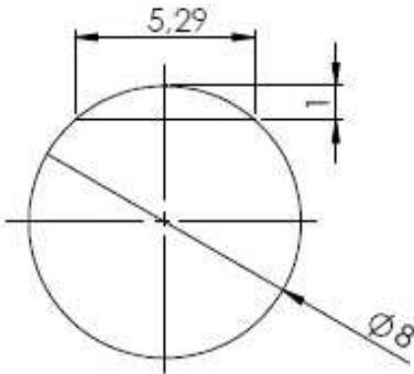
Slika 4.16 Prikaz glodala  $\Phi 8$  u bočnom zahvatu 1 mm
