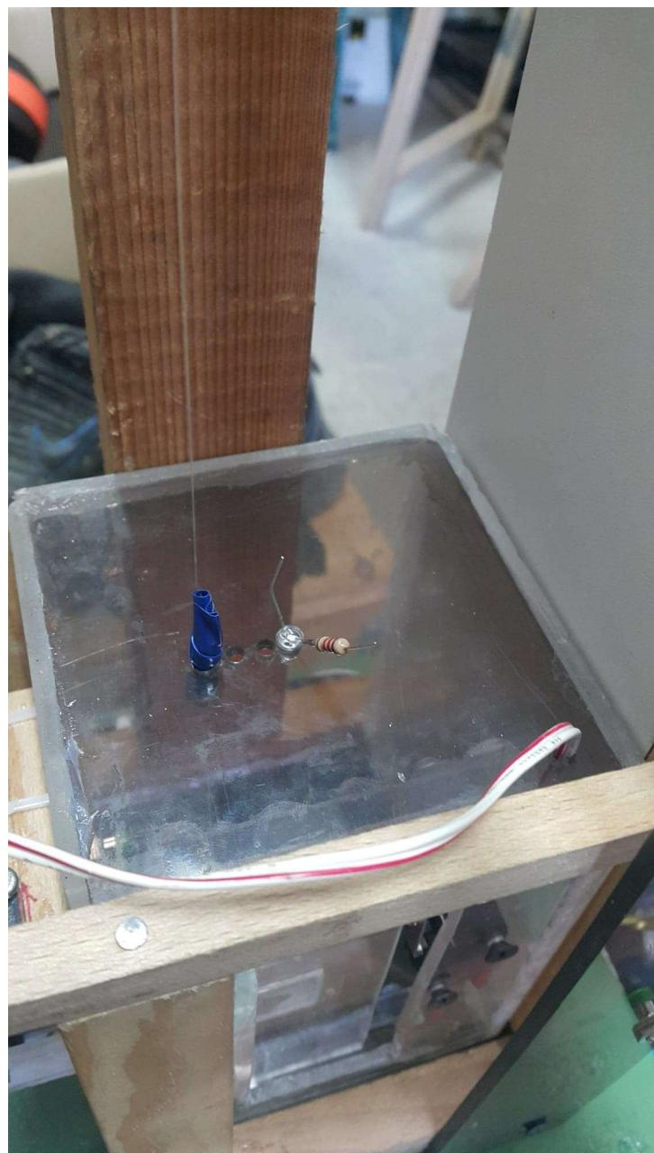
*Slika 3.15. Postavljanje LED diode kao rasvjeta u dizalu*
