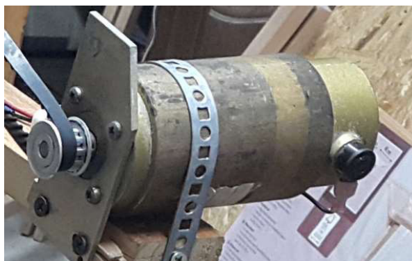
Slika 3.3. DC motor za pogon dizala
