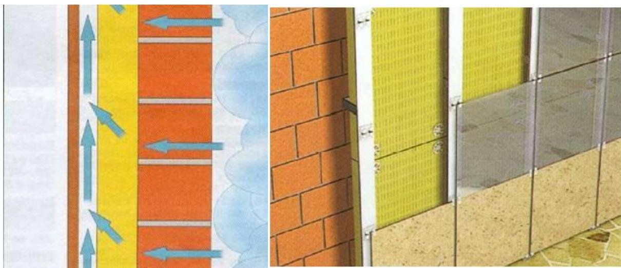
Slika 28., 29. Prikaz ventilirane fasade
