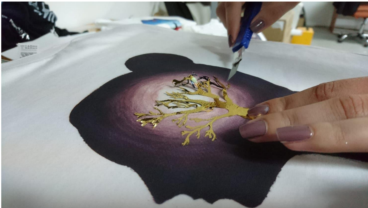
Slika 3.6 Postupak ručnog prenošenja termo folije na tekstil
