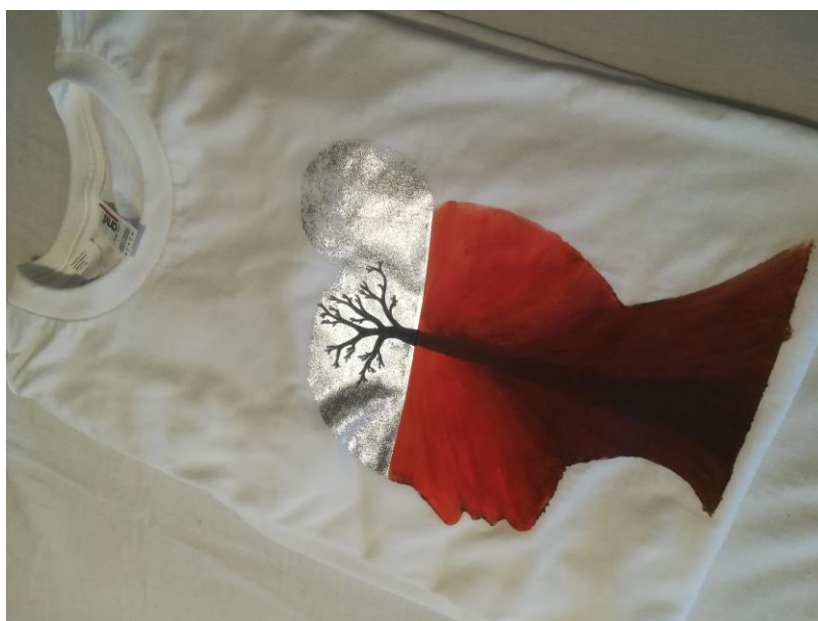
Slika 3.5 Otisak ilustracije na bijelu majicu sa termo transfer folijom
