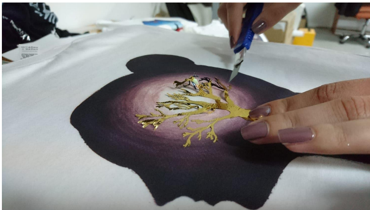
Slika 3.6 Postupak ručnog prenošenja termo folije na tekstil
