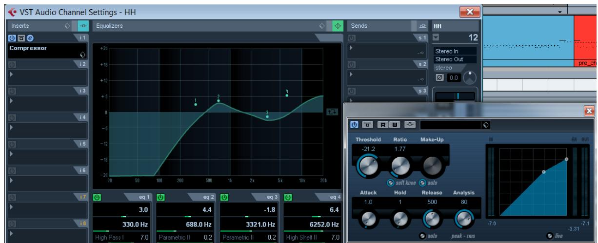
Slika 6.9 - efekti mikrofona hi-hat činele
