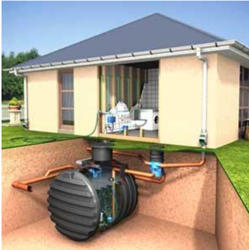
Slika 21. Detalj primanja i odvoza vode iz kišnice
