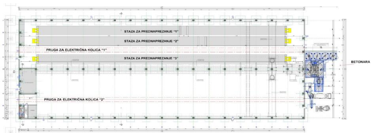
Slika 5. Tlocrtni prikaz tvornice za predgotovljene betonske elemente
