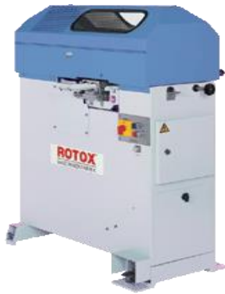
Slika 7. Pila letvica za staklo
