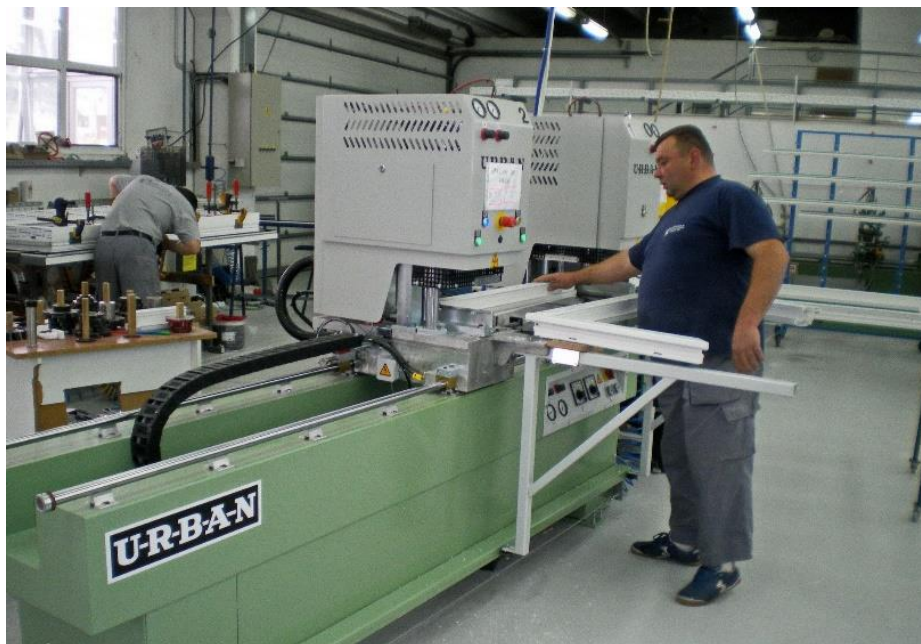
Slika 4. Varilica profila u pogonu
