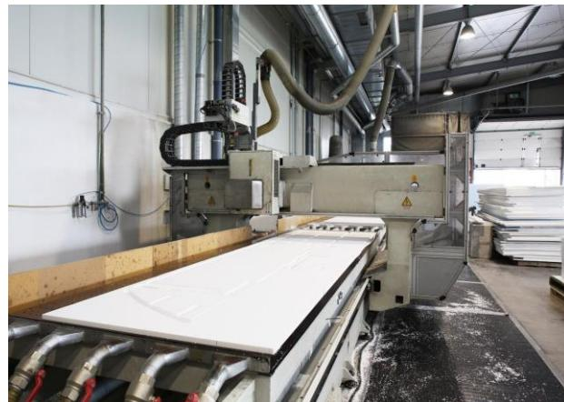
Slika 7: Stroj za rezanje EPS
