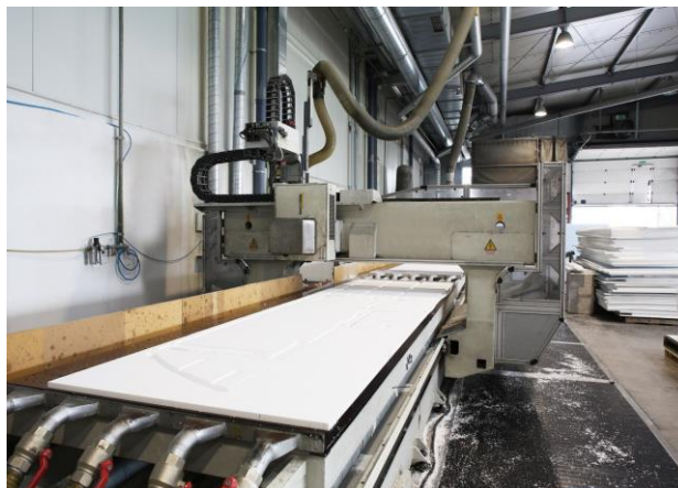
Slika 7: Stroj za rezanje EPS
