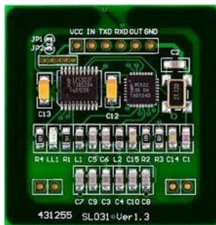
Slika 5.4. RFID modul SL031 Ver1.3 [11]
