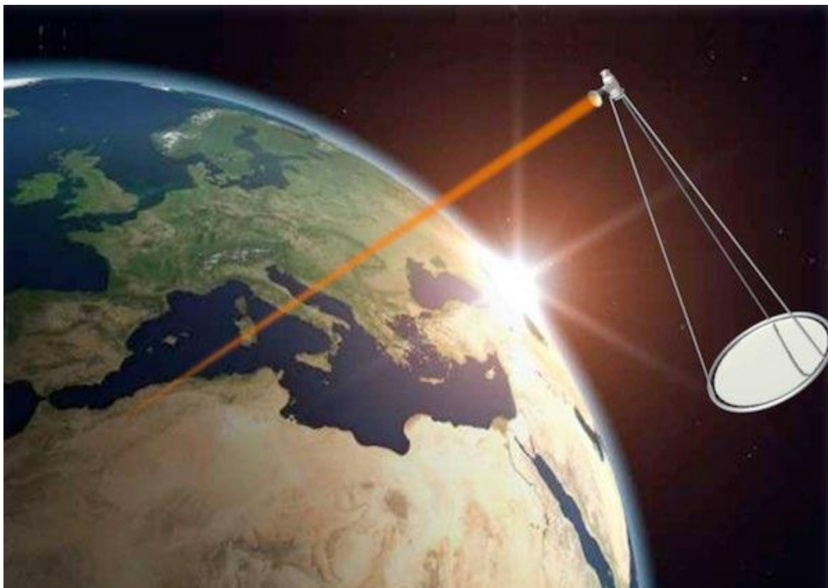
Slika 5.1 Koncept satelita koji skuplja solarnu energiju, pretvara ju u laser i šalje lasersku zraku na prijamnik na Zemlji [33]
