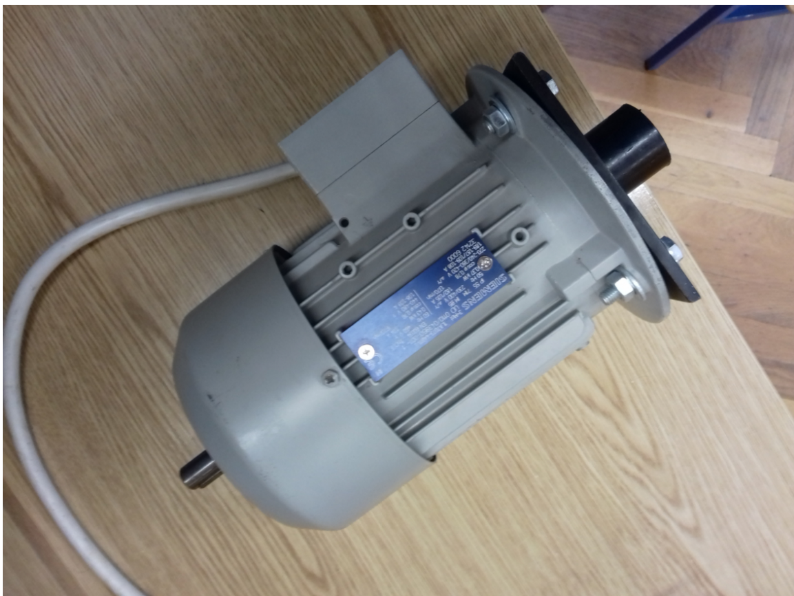
Slika 3.4 Asinkroni motor iz laboratorija
