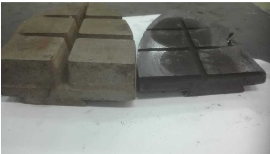
Slika 14: Nova i istrošena kočiona papuča [14]
