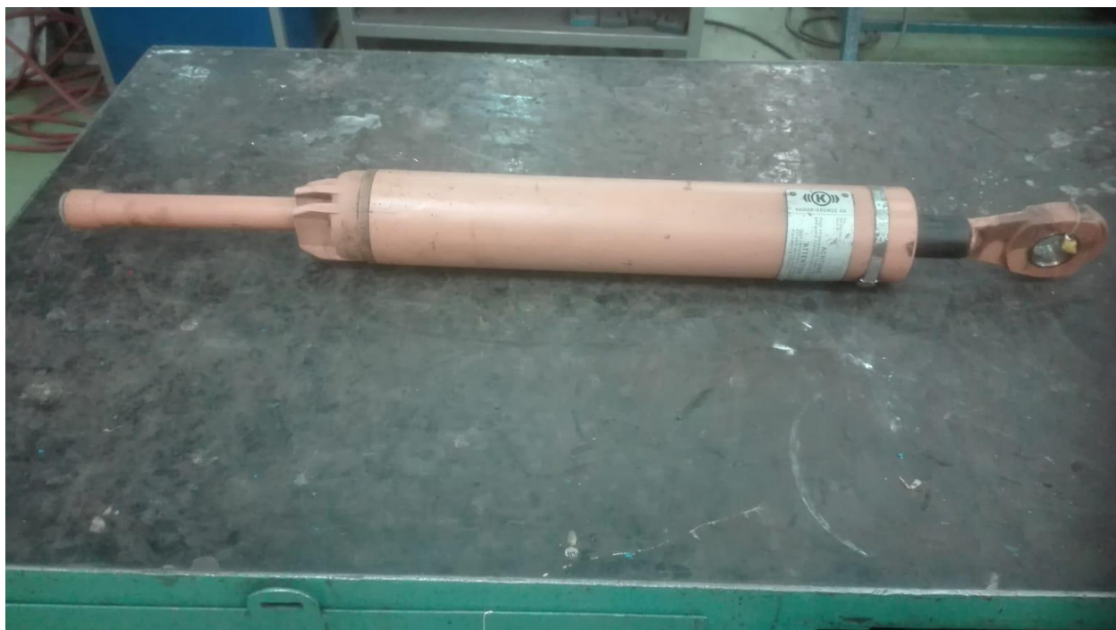
Slika 4:Regulator kočnog polužja [4]
