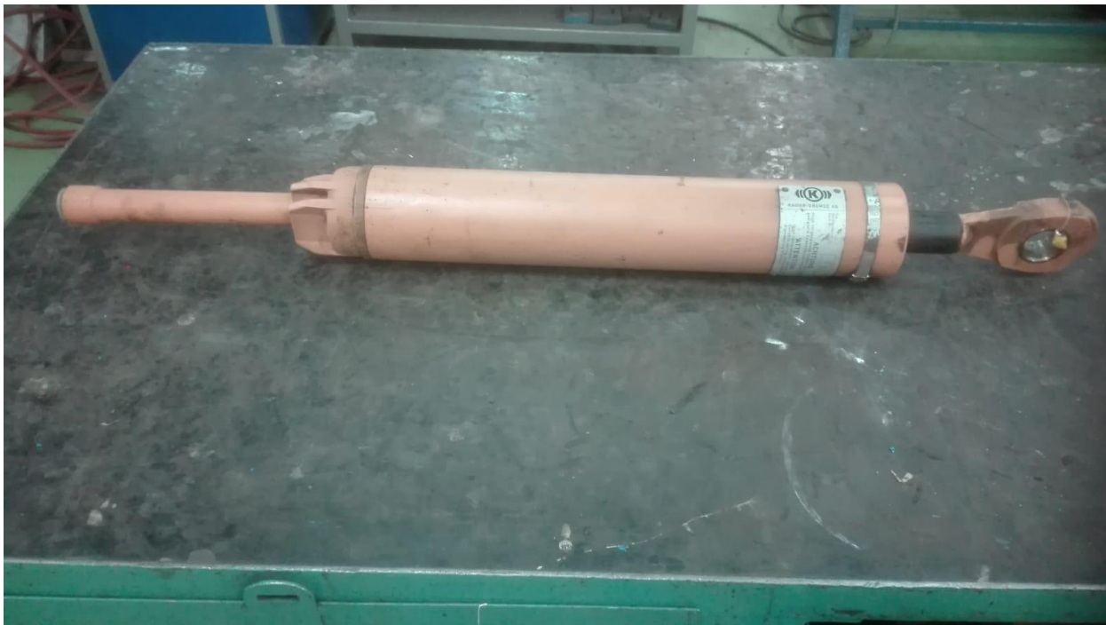
Slika 4: Regulator kočnog polužja [4]
