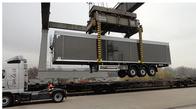
Slika 25. Huckepack tehnologija B
