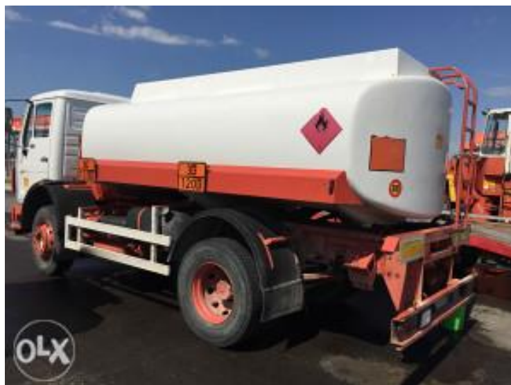
Slika 19: Prikaz cisterne integrirane na kamion sa oznakama opasnosti ( https://s6.pik.ba/galerija/2016-06/15/07/slika-1057416-57619050d24f4-default.jpg )
