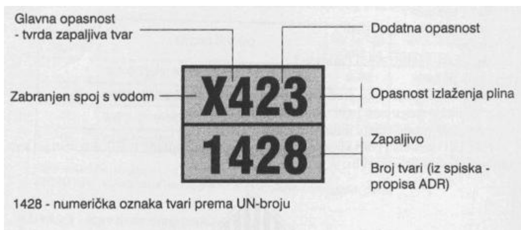
Slika broj 15: Značenje brojeva na listici opasnosti
