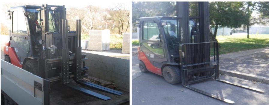
Slika 3.8. Novi viličari sa dvostrukim prihvatom paleta i stari viličar sa prihvatom samo jedne palete
