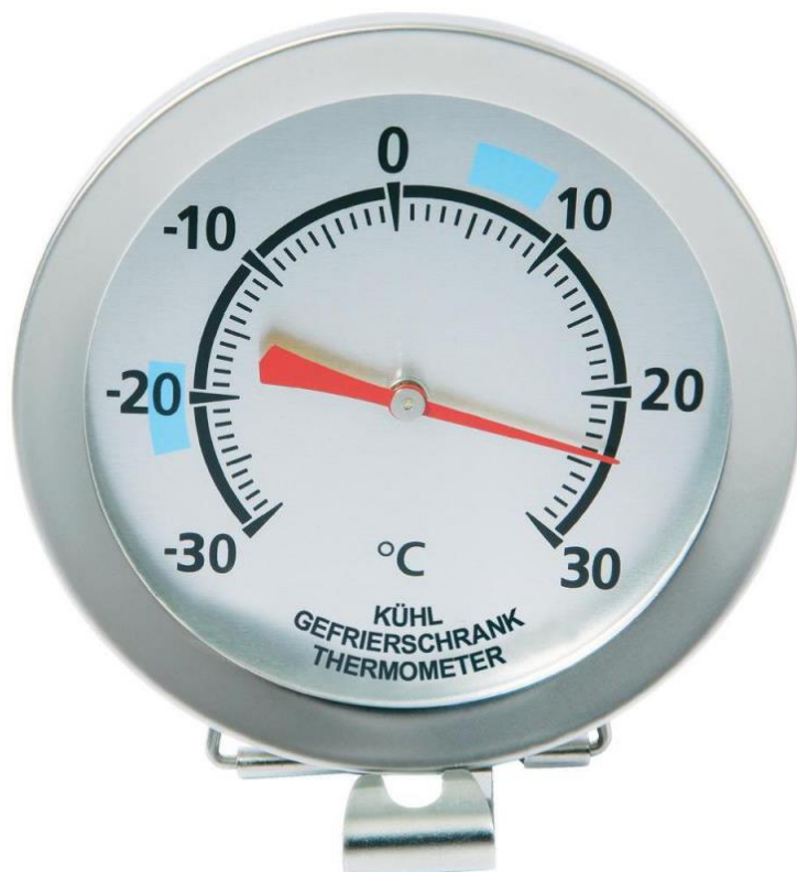
Slika 4. Termometar za mjerenje temperature u komori
