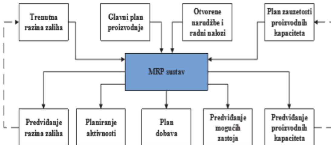
Slika 3.4 Dijelovi MRP sustava
