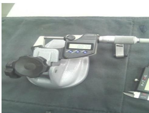
Slika 3. Digitalni mikrometar
