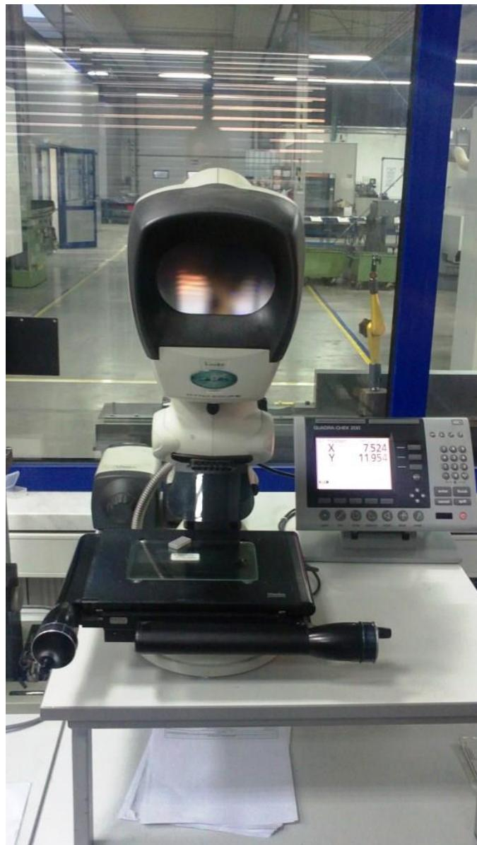
Slika 12. Mjerni mikroskop
