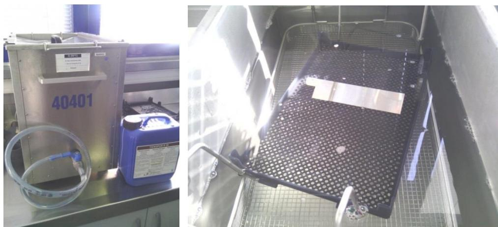
Slika 55. Postavljanje komada za ultrazvučnu kupku
