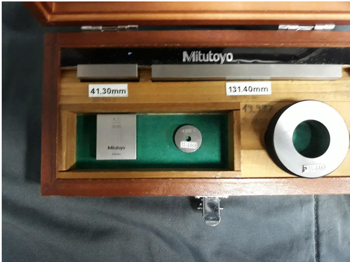
Slika 31. Set za kalibraciju pomičnih mjerila 0 - 150 mm
