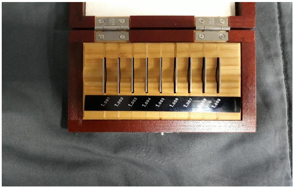
Slika 28. Set za kalibraciju mjernih ura BN 0002
