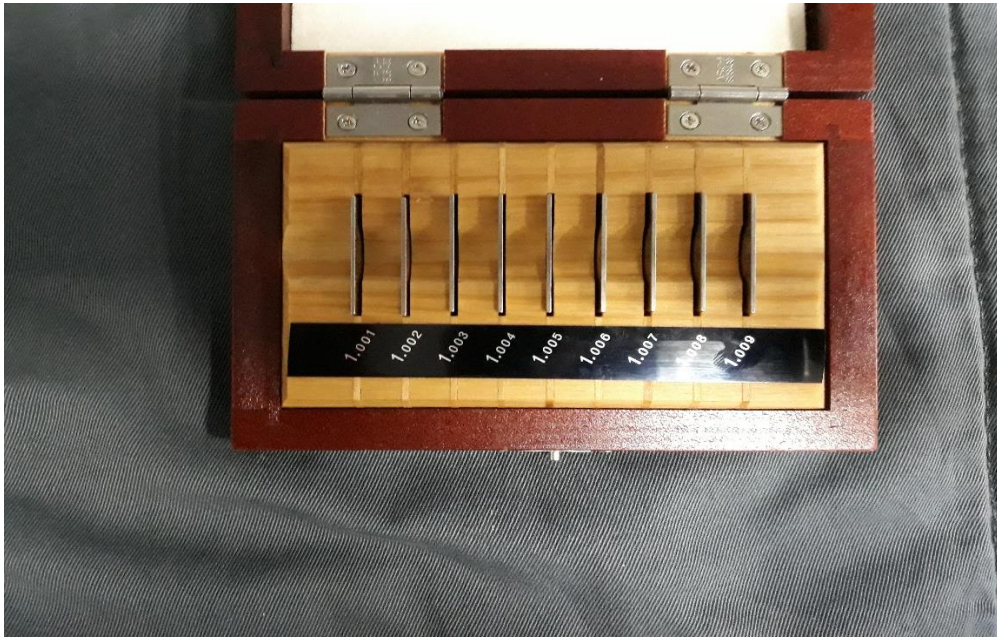
Slika 28. Set za kalibraciju mjernih ura BN 0002
