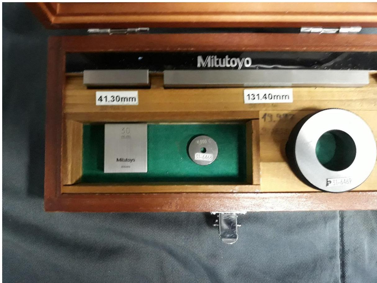
Slika 31. Set za kalibraciju pomičnih mjerila 0 - 150 mm
