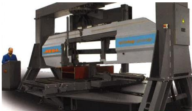
Slika 3.4 Zaštitna naprava za daljinsko upravljanje [1]
