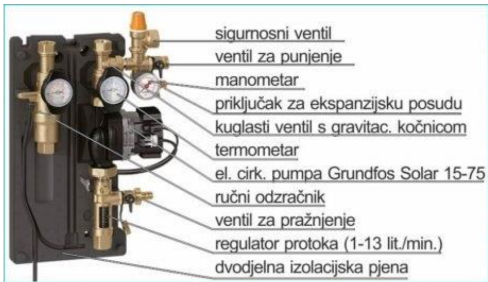
Slika 2.8. Solarna pumpna grupa [5]
