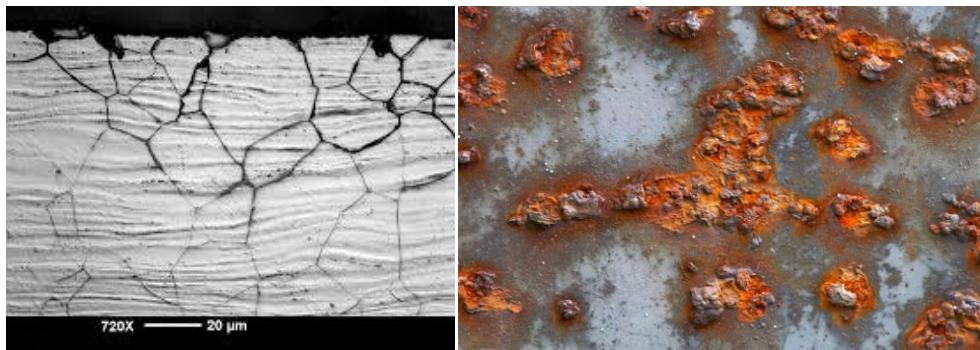
*Slika 9. Interkristalna korozija pod mikroskopom i pod golim okom [30, 31]*
