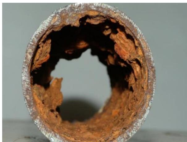
*Slika 2. Kemijska korozija u ispušnoj cijevi [44]*
