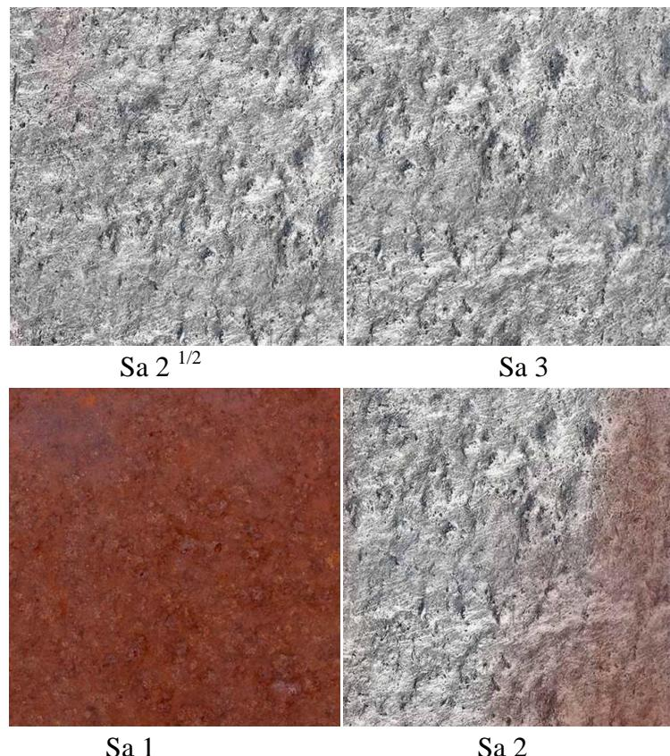
Slika 40. Prikaz četiri stupnja čišćenja površine substrata[21]
