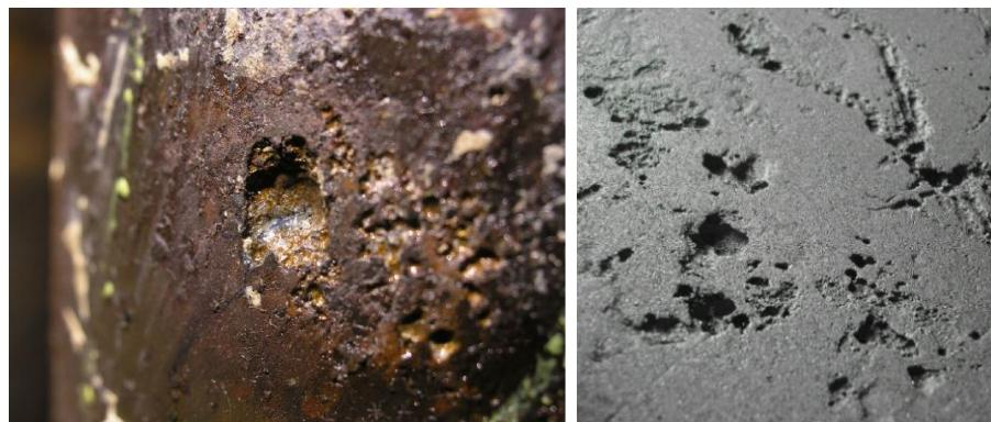
*Slika 5. Primjeri rupičaste korozije [25,46]*
