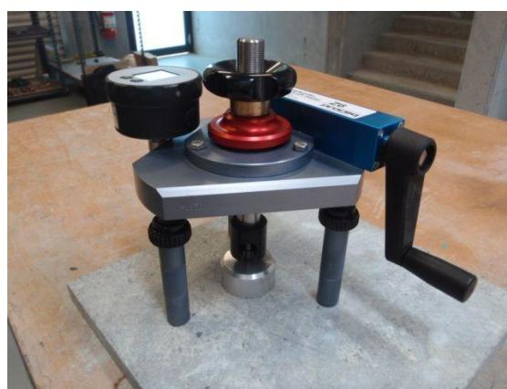
*Slika 37. Slika sprave za ispitivanje kvalitete premaza[42]*
