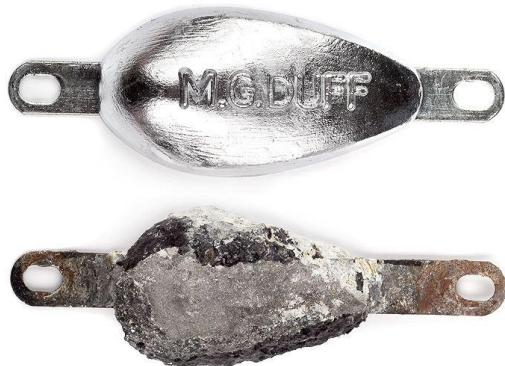
Slika 12. Primjeri istrošenih anoda[32]
