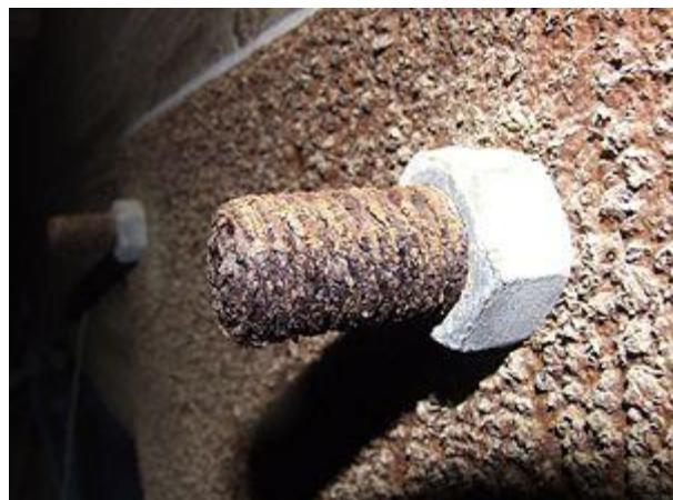
Slika 3. Elektrokemijska korozija u spremniku s vodom [45]
