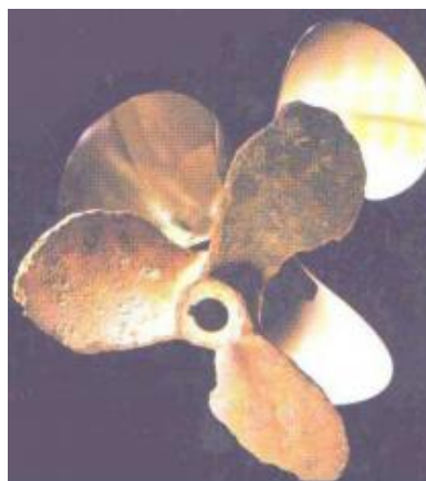
Slika 10. Selektivna korozija, decinkacija mjedi [47]
