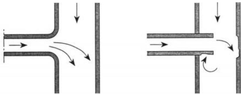
Slika 17. Pravilno konstruiranje cjevovoda [22]
