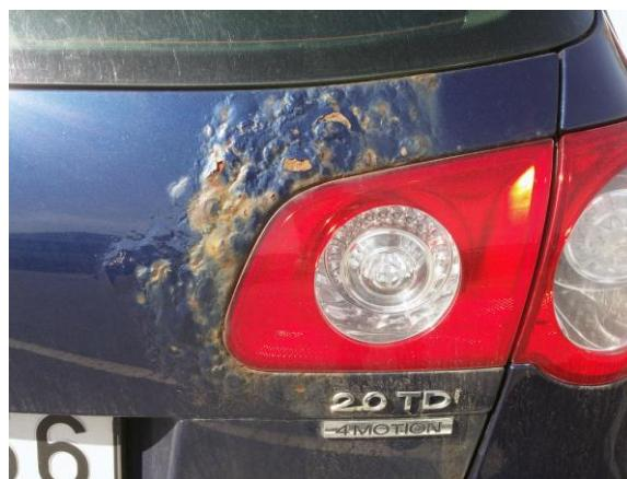
*Slika 6. Potpovršinska korozija na automobilu [26]*
