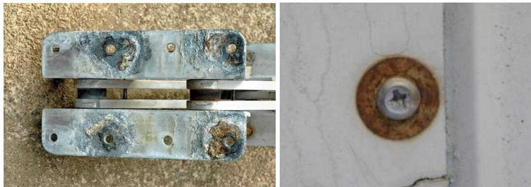
Slika 7. Galvanska korozija okovnja, korozija ploške u spremniku [4, 27]
