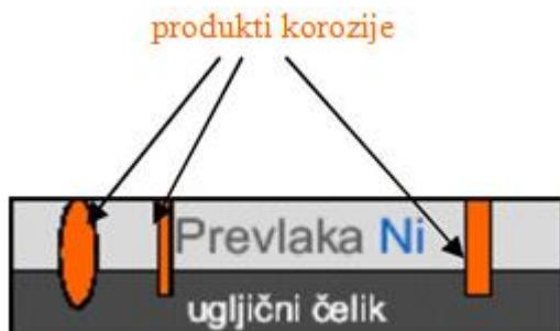
Slika 18. Katodna prevlaka nikla na čeliku[9]
