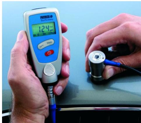
*Slika 36. Uređaj za mjerenje debljine suhog filma[41]*
