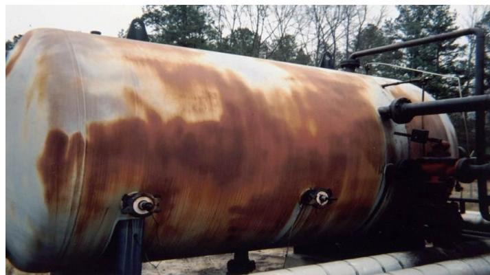
Slika 4. Primjer opće korozije na spremniku[24]
