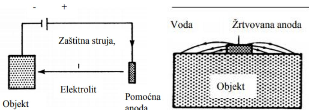
Slika 11. Katodna zaštita strujom i žrtvovanom anodom pričvršćenom na objekt koji se štiti[7]
