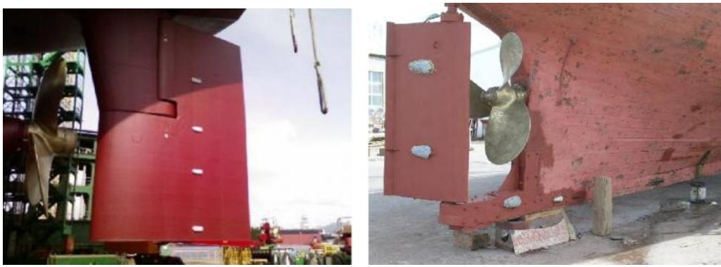
*Slika 13. Primjeri katodne zaštite cinkovim protektora[7]*
