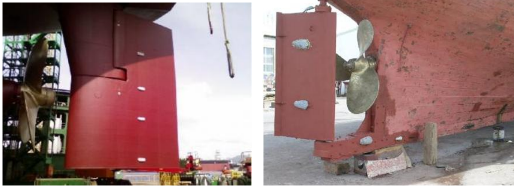
Slika 13. Primjeri katodne zaštite cinkovim protektora[7]
