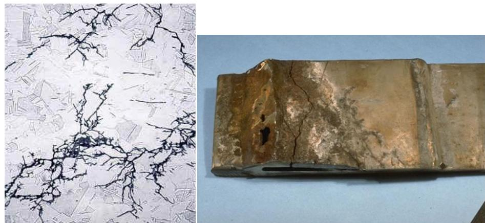
Slika 8. Napetosna korozija [28, 29]
