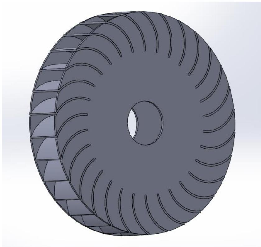
Slika 5.4. Rotor turbine
