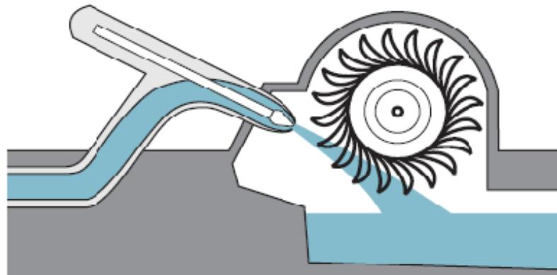
Slika 3.3. Pelton turbina
