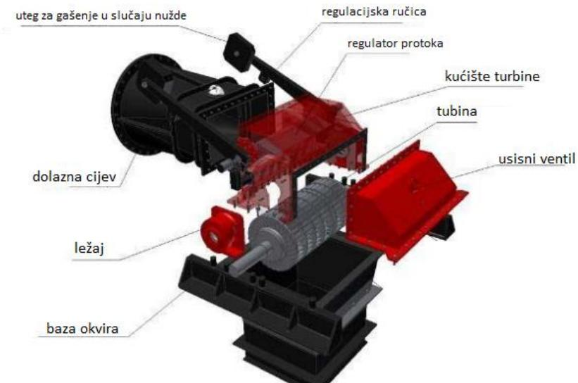
Slika 5.1. Crossflow turbina
